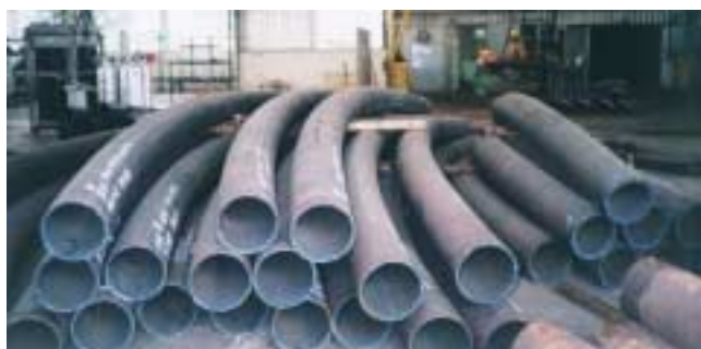
Figura 8.13 – Perfis curvados pelo processo de indução por alta frequência.
