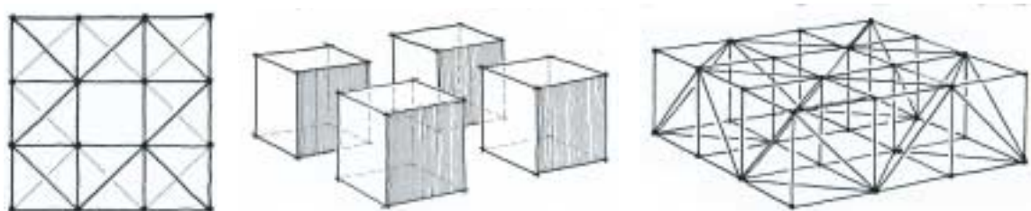
Figura 2.4 – Malha ortorrômbica. (a) projeção horizontal. (b) grupamento dos poliedros. (c) grupamento somente de arestas e nós. Fonte: Sá, 1982.
