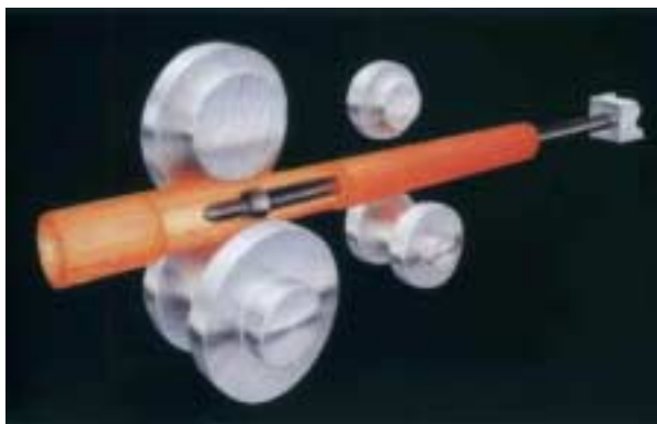
Figura 4.2 – Processo de laminagem de tampão. Fonte: V&M, 2002.
