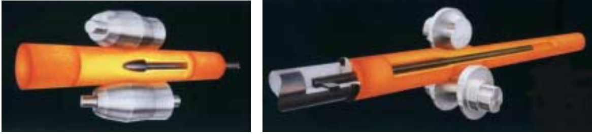
Figura 4.3 – Processo de laminagem. (a) por perfuração. (b) por cilindragem.
