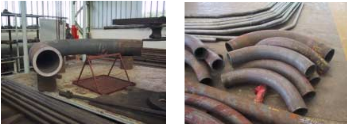
Figura 4.13 – Curvamento de peças com espessuras diferenciadas. Fonte: foto do autor.
