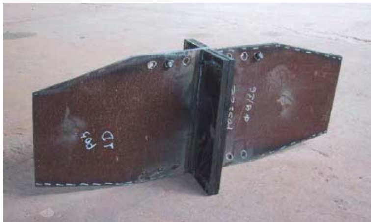
Figura 8.11 – Conjunto de quatro chapas soldadas, parafusadas entre si.
