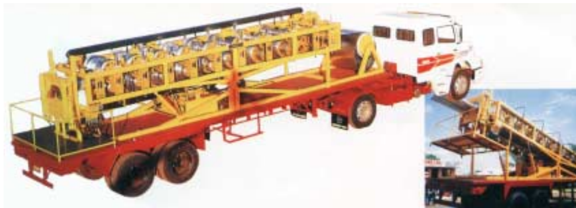
Figura 4.16 – Equipamento de conformação dos painéis. Fonte: Imasa, 2002.
