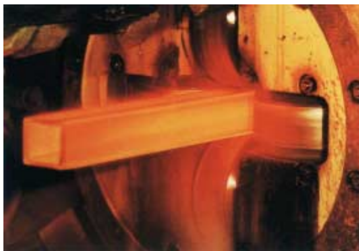
Figura 4.9 – Processo por laminagem. Fonte: V&M, 2002.
