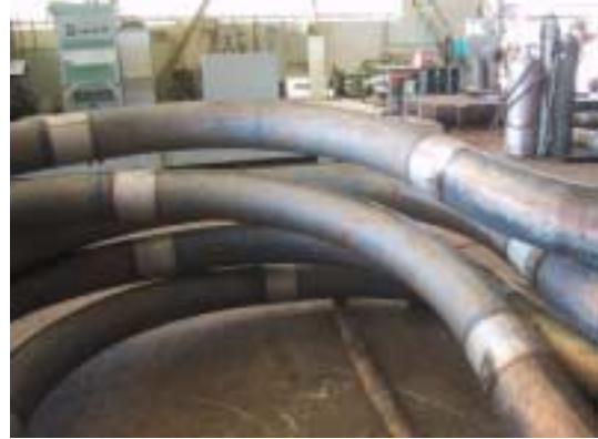
Figura 4.11 – Trechos com inversão de curvatura. Fonte: foto do autor.
