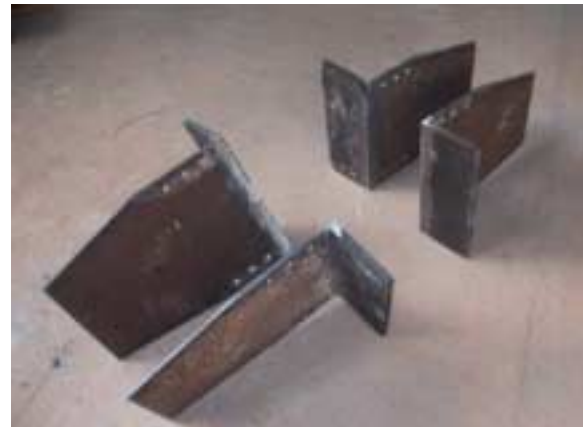
Figura 8.10 – Conjunto de quatro chapas soldadas.
