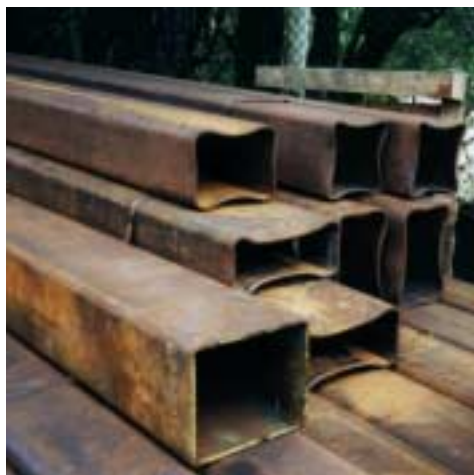
Figura 4.8 – Tubos com borda deformada, ainda por receber arremate. Fonte: foto do autor.
