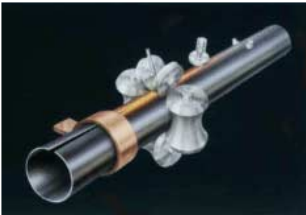
Figura 4.4 – Desenho esquemático do processo de soldagem por indução de alta frequência.
