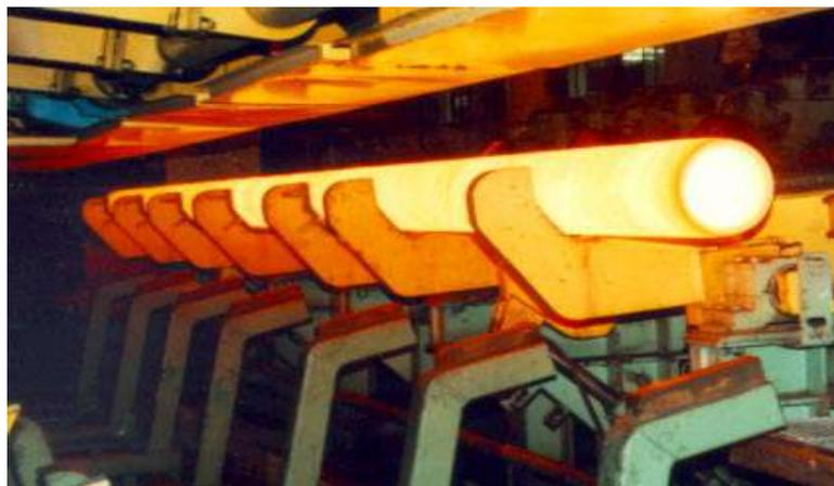
FIGURA 3.4 - Processo de laminação a quente dos tubos sem costura
