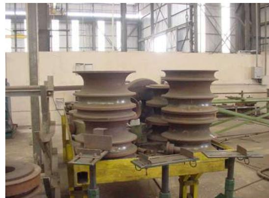
FIGURA 5.29 - Calandra de tubos: (a) máquina para calandragem; (b) rolos de calandragem
