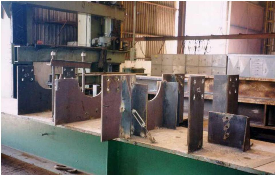
FIGURA 5.2 - Galpão AçoTubo: gabarito de fabricação de pilares tubulares de seção circular
