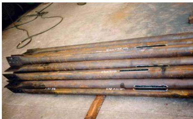
FIGURA 5.17 - Rasgos executados no meio do tubo para ligação com chapa plana
