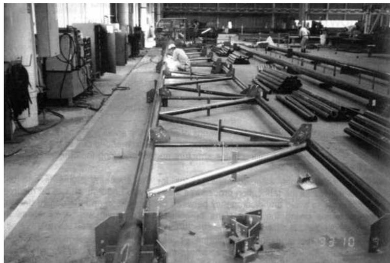
FIGURA 5.4 - Gabarito para uma viga treliçada do tipo Warren
