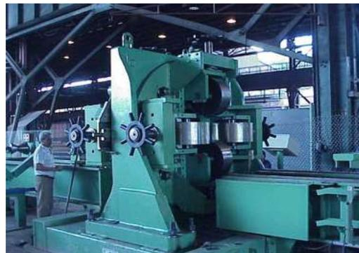
FIGURA 3.6 - Sistema perfilador cabeça-turca – VMB, Belo Horizonte-MG
