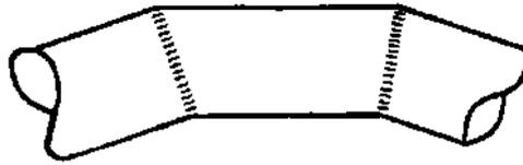
FIGURA 5.30 - Corte angular e solda de curva de gomos
