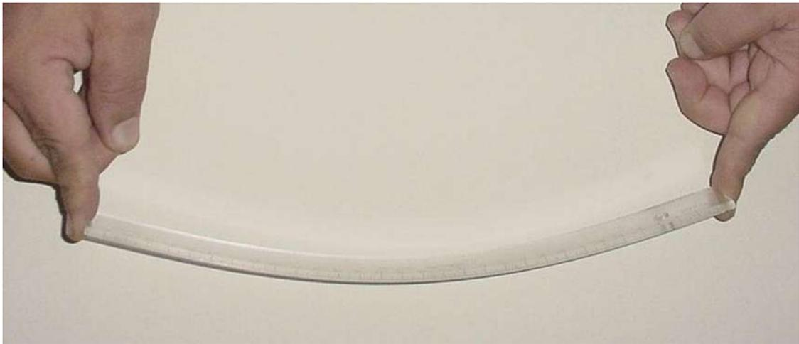
FIGURA 3.11 - Perda de estabilidade de uma barra reta solicitada a compressão
