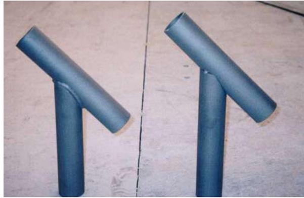
FIGURA 5.10 - Ligação de dois tubos de seção transversal circular executada com dois cortes planos
