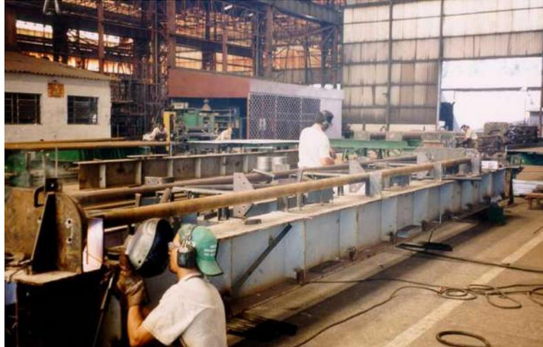
FIGURA 5.3 - Galpão AçoTubo: bancada gabarito para fabricação de tesouras treliçadas tubulares
