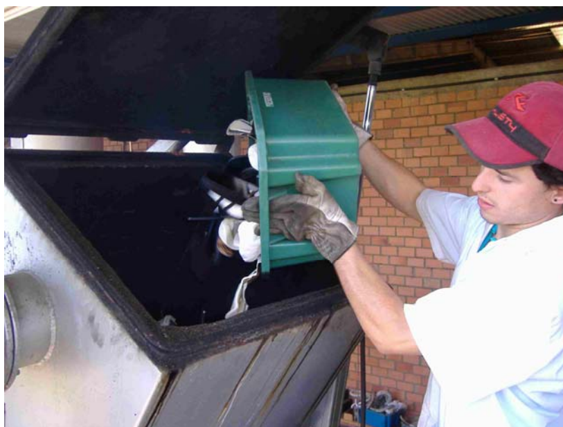
Figura 15: Alimentação manual do resíduo
