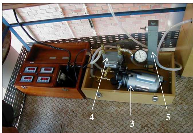
Figura 29: Sistema de amostragem (caixa de controle e acessórios)
