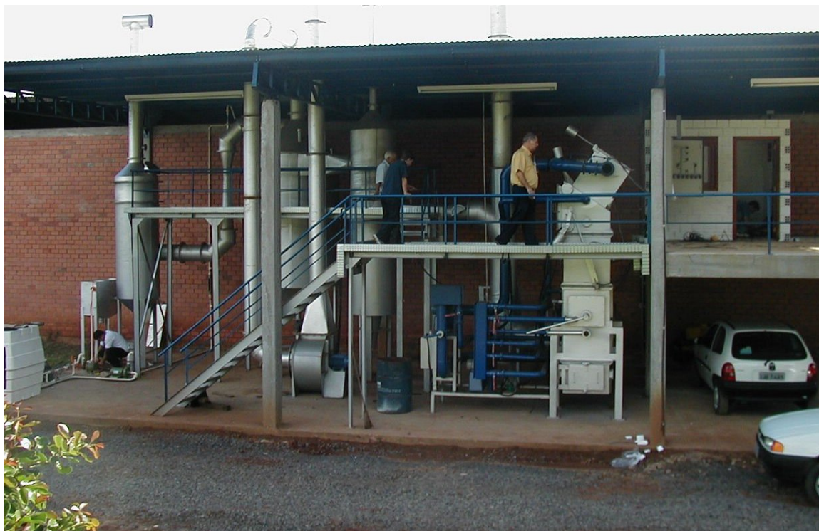
Planta piloto para a gaseificação e combustão de resíduos da indústria Calçadista
