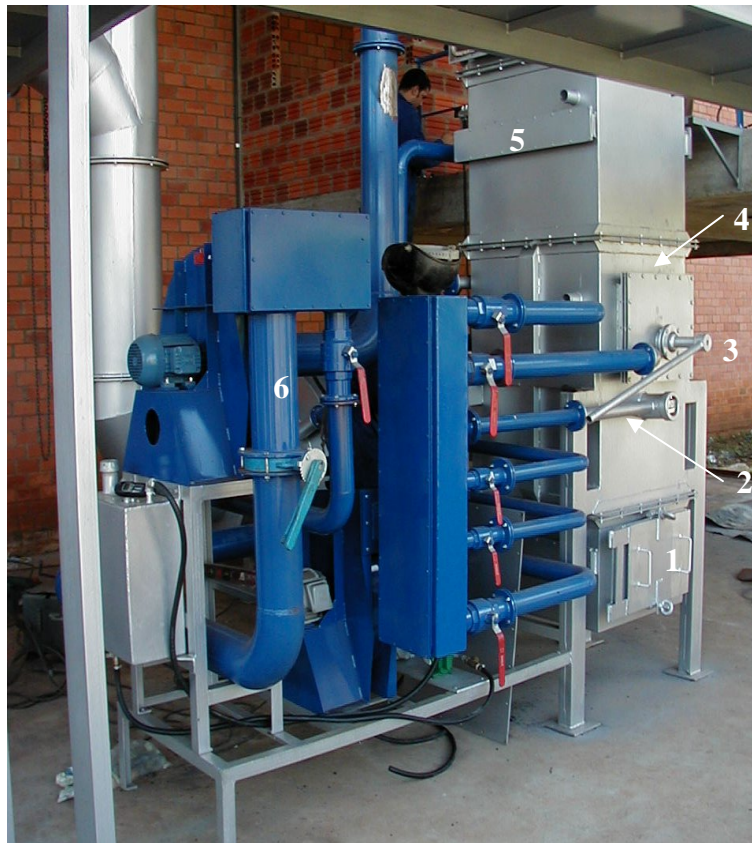
Figura 16: Vista da parte inferior do reator de gaseificação e zona primária de combustão (1.cinzeiro; 2.ar primário; 3.grelha; 4. zona de redução; 5.injeção do agente de gaseificação (ar); 6.ar terciário)
