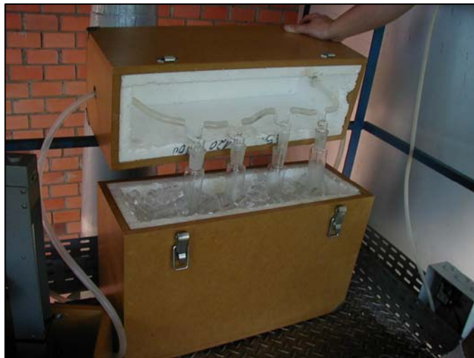
Figura 27: Sistema de amostragem (sonda e cápsula )
