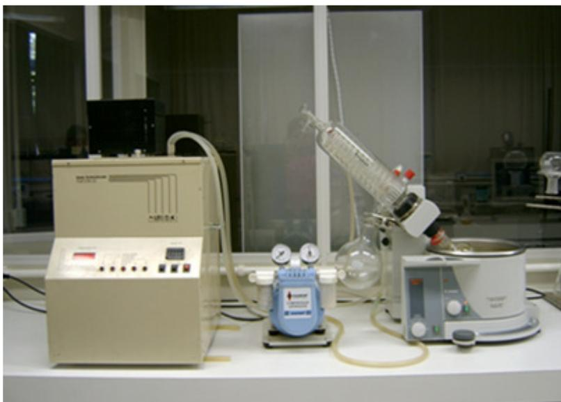
Concentração do extrato em evaporador rotatório.
