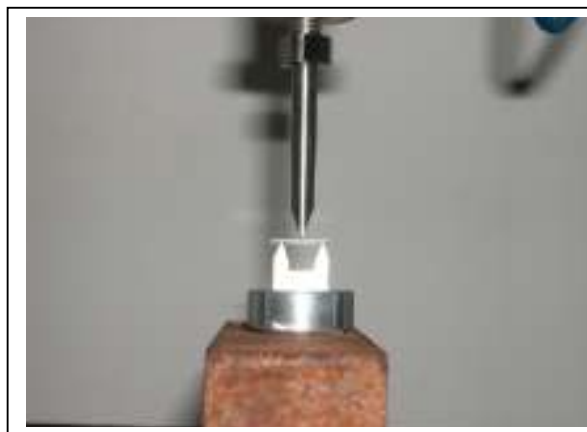
Figura 18- Conjunto dos elementos para realização do teste dos três pontos.
