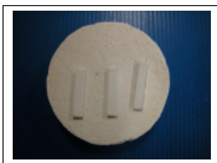
Figura 10- Barras de massa cerâmica sobre a lã de vidro.
