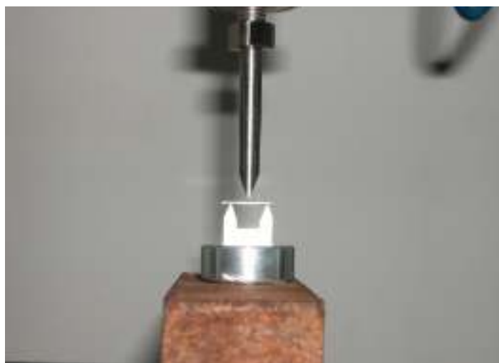
Figura 24 - CP sendo submetido ao teste dos três pontos.
