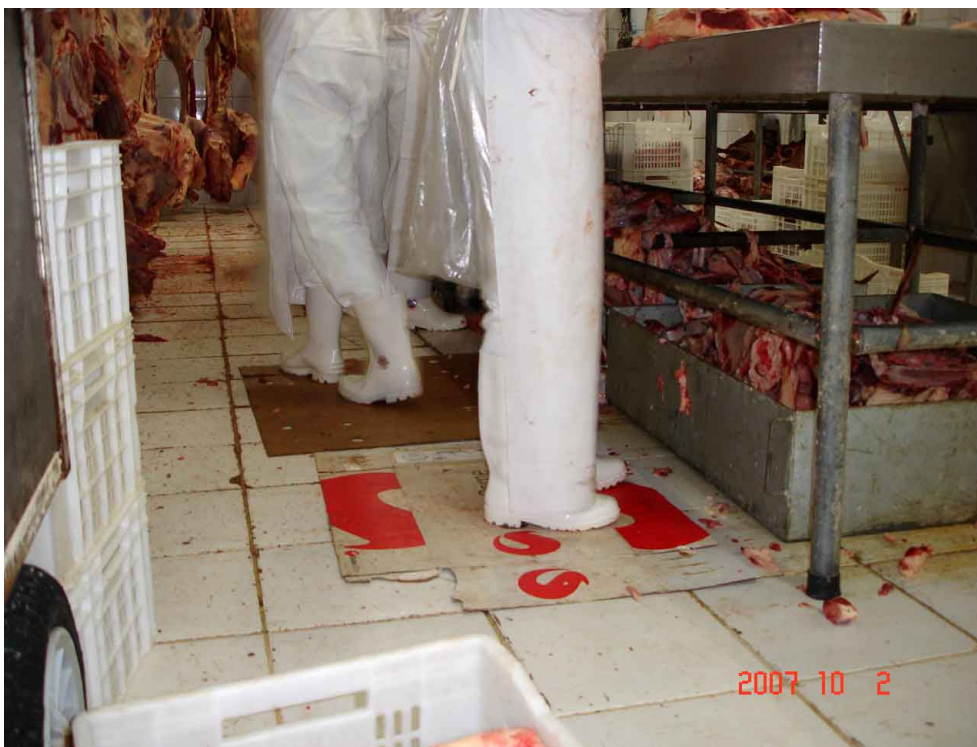
Figura 68: Utilização de papelões para evitar acidentes e/ou risco de quedas. Fonte: A autora (2008)
