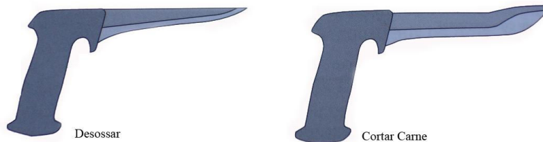
Figura 25: Facas com desenho diferenciado para cada tipo de uso. Fonte: OIT, (2001, p.89).
