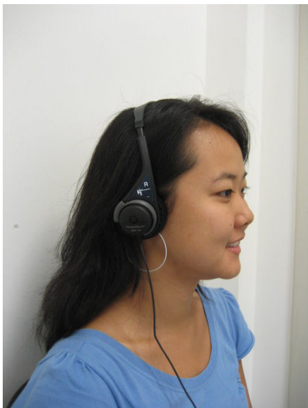
Figura 33: Combinação fone/microfone biaural MHS III utilizado junto ao gravador SQuadriga. Fonte: A autora (2008).
