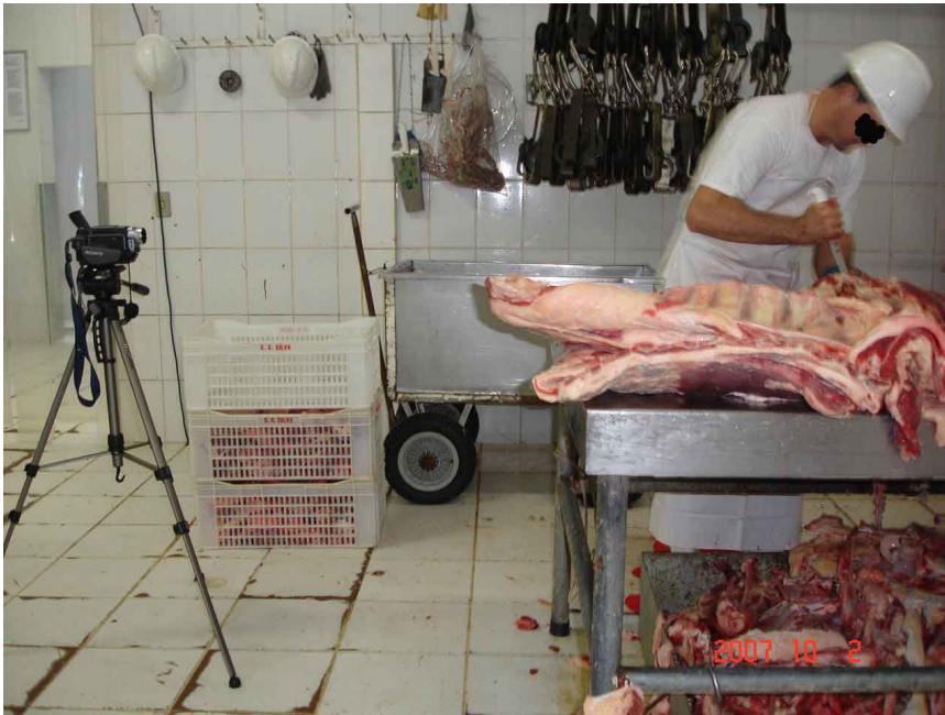
Figura 34: Vista lateral da filmagem da atividade de desossa para contagens de tempos e movimentos.
