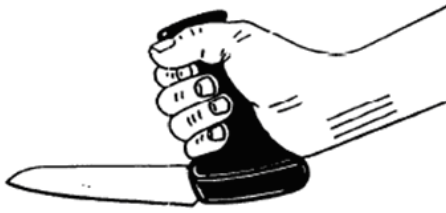
Figura 26: Faca com pega em punhal. Fonte: Grant e Habes (1997, p.137).
