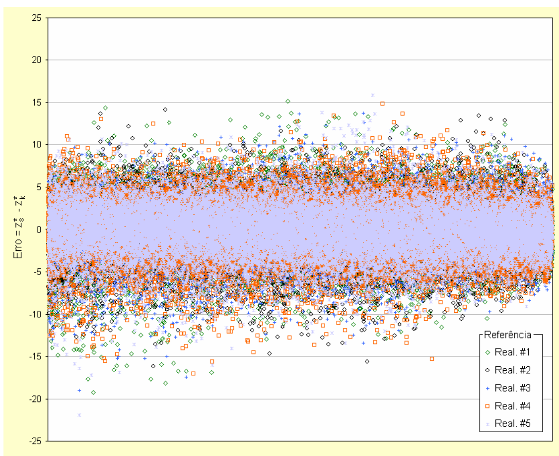
Figura 5.44. Comparativo do comportamento dos erros ou resíduos com a mudança da realização utilizada como referência, para os blocos de recurso medido, classificados a partir do erro padrão calculado por meio da variância de krigagem.
