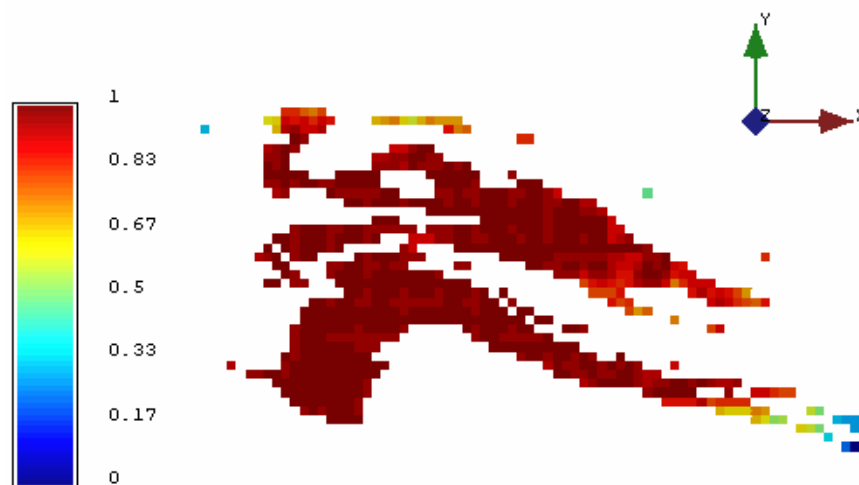
Figuras 4.25. Seção horizontal, para o nível 970, com a distribuição de probabilidades dos blocos serem considerados como recurso medido.
