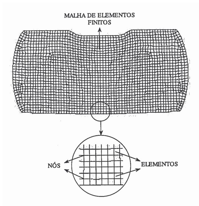
Figura 2.16 – Peça discretizada por elementos finitos [28].
