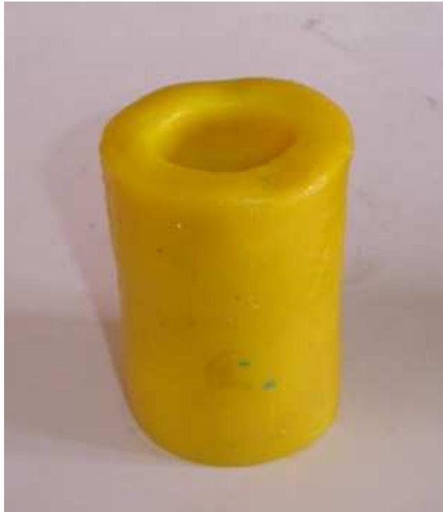
Figura 4.11 - Peça de plasticina forjada com altura inicial de 56mm não mostrando formação de rebarba com volume de 63845mm<sup>3</sup>.
