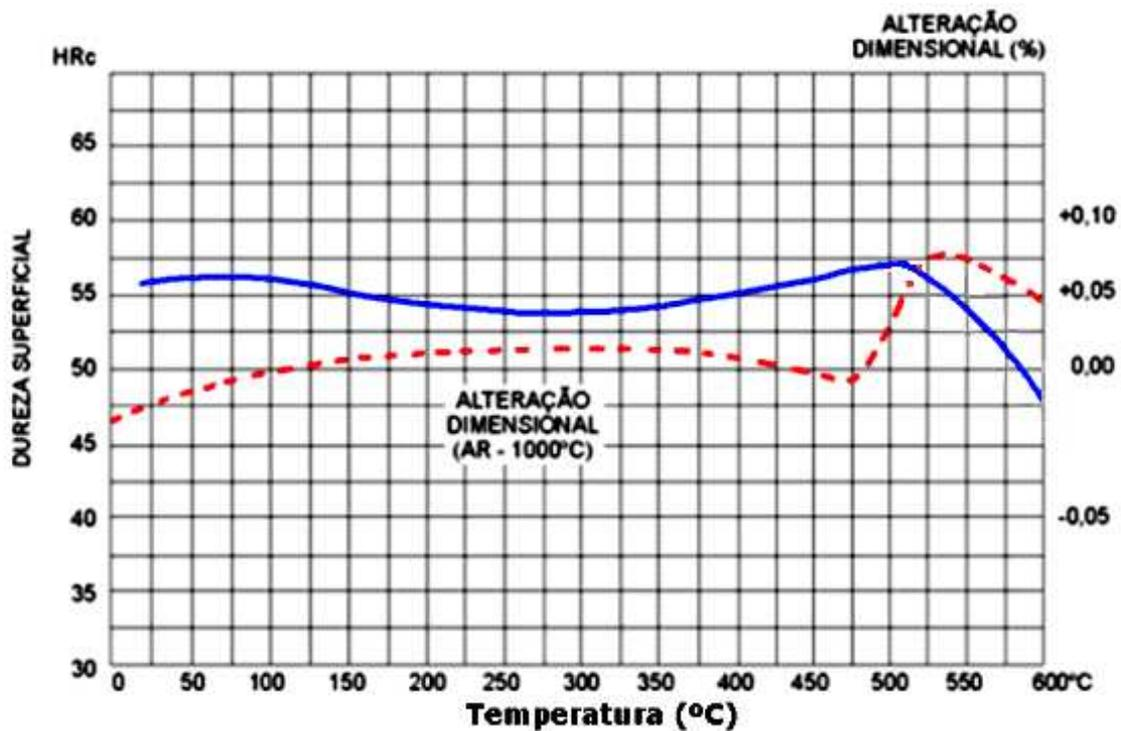
Figura 2.22 – Diagrama de revenimento do aço AISI H13 [38]
