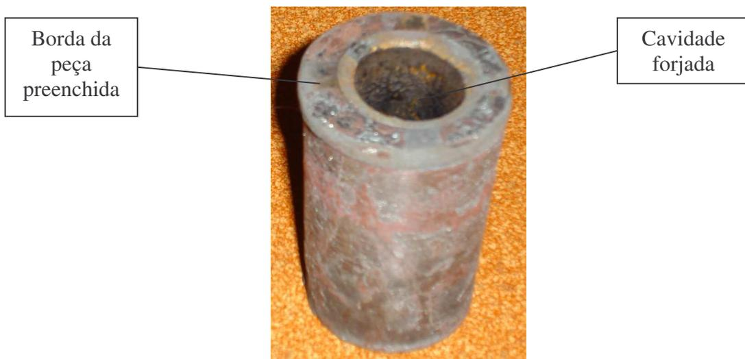
Figura 5.16 – Peça forjada com a produção completa da pré-forma.
