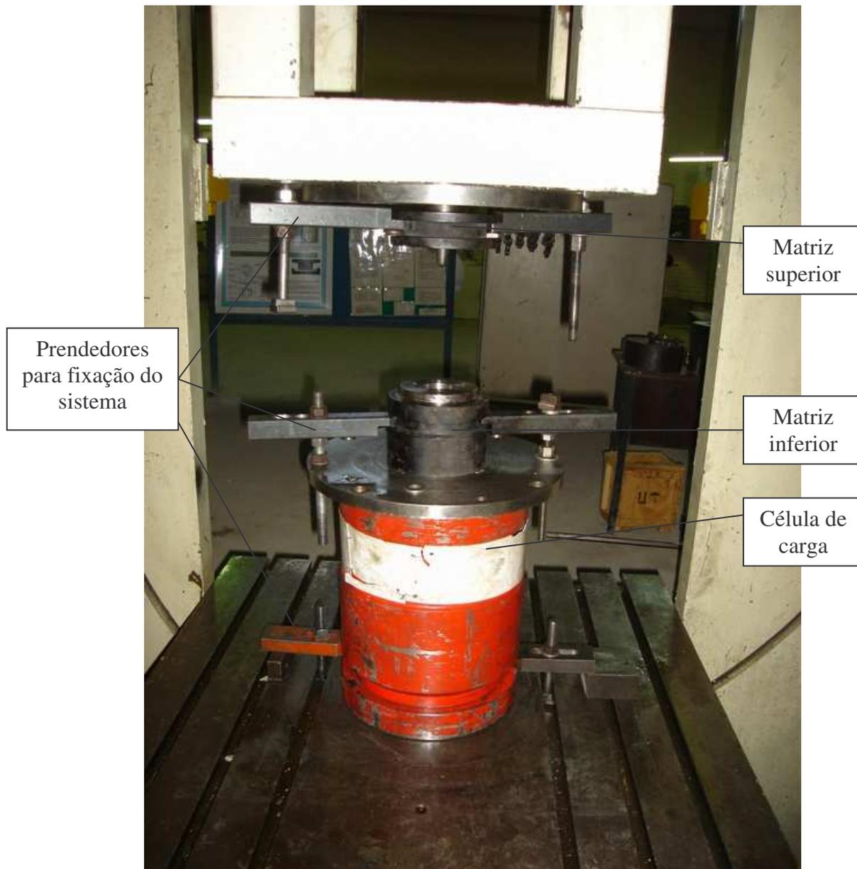
Figura 5.11 – Sistema montado para realização do processo.
