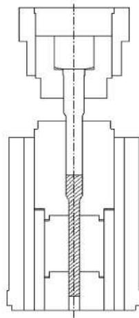
Figura 2.9 – Peça sendo extrudada de forma direta [18].
