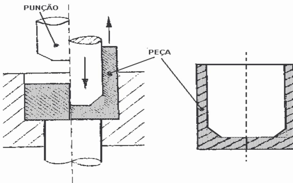
Figura 2.4 – Peças obtidas por extrusão indireta [2].
