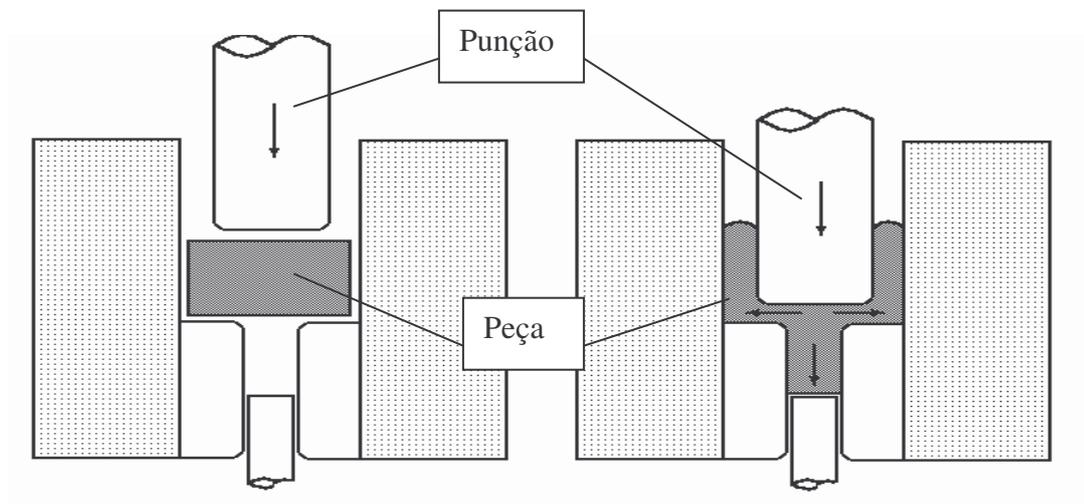
Figura 2.13 – Processos de extrusão direta e indireta combinados.
