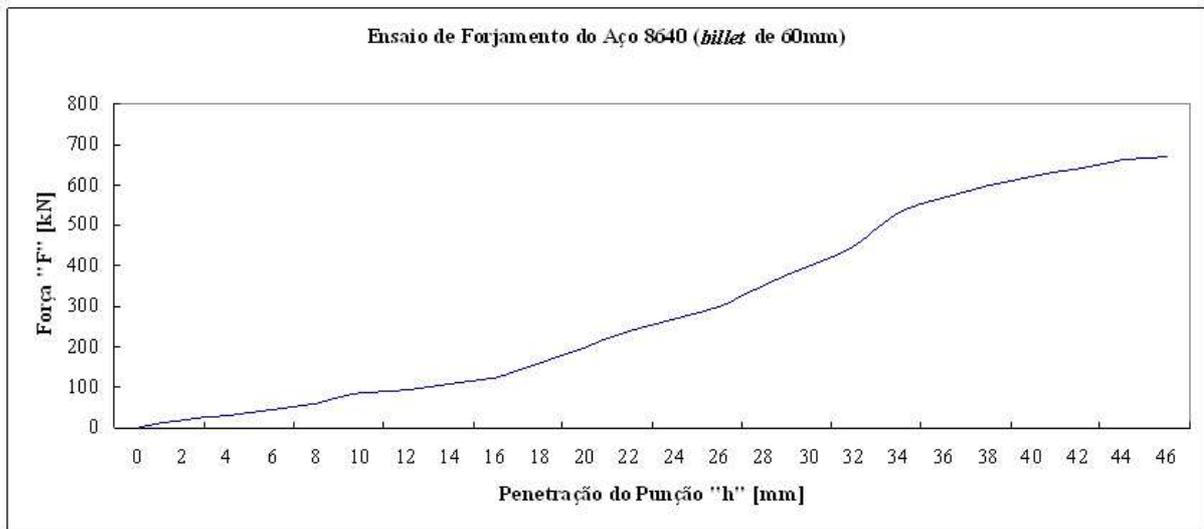
Figura 5.17 – Força necessária para a penetração total do punção em um *billet* de altura inicial de 60mm.
