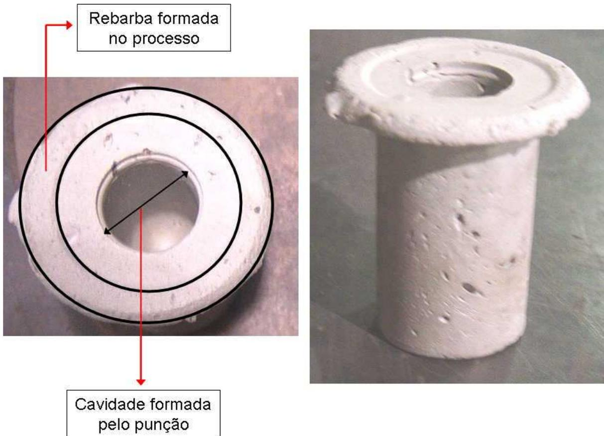
Figura 4.9 – Peça de gesso mostrando excesso de material.
