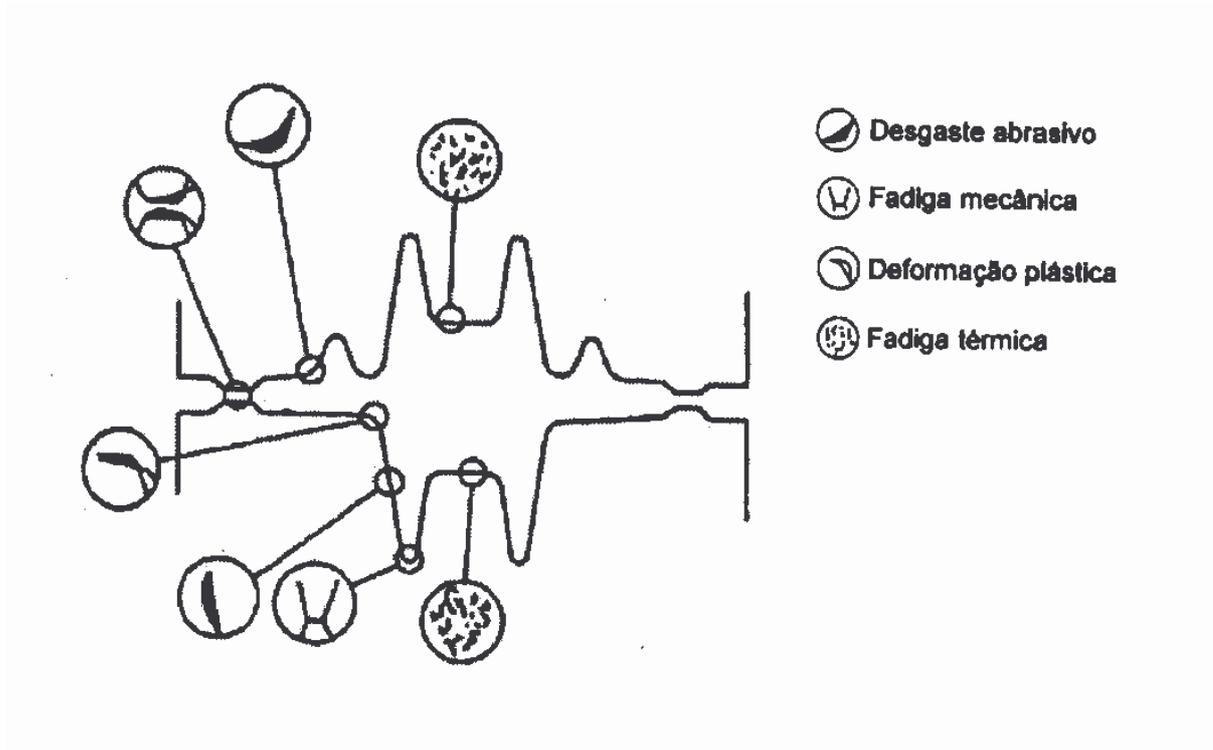
Figura 2.20 – Modos de falha característicos de ferramentas de forjamento a quente [3]
