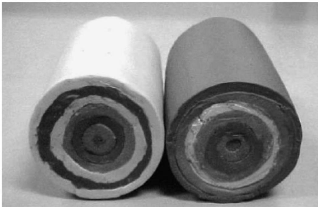
Figura 2.14 – Cilindros de plasticina confeccionados para posterior ensaio [20].
