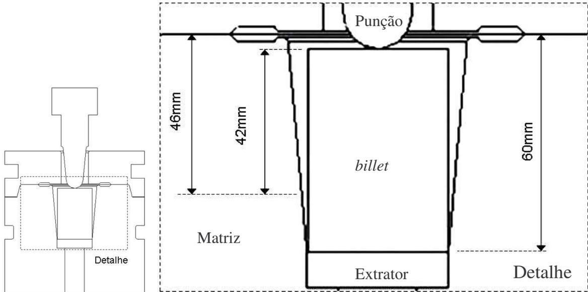
Figura 4.16 – Altura de penetração do punção.
