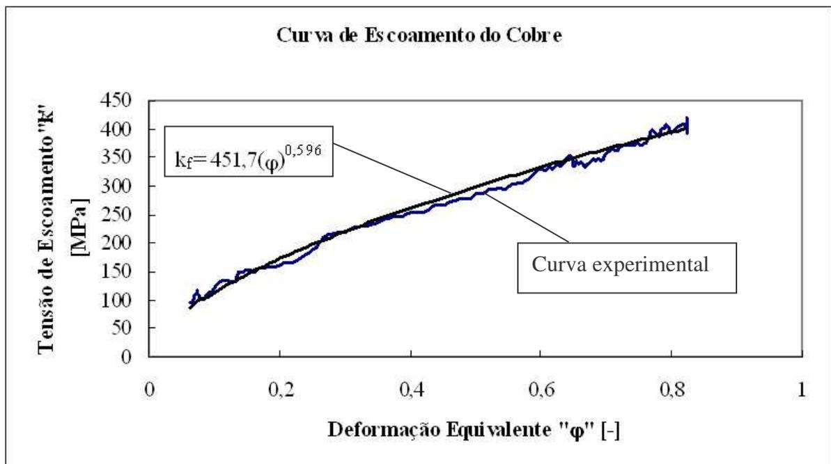
Figura 6.1 – Curva de escoamento do cobre a temperatura ambiente.
