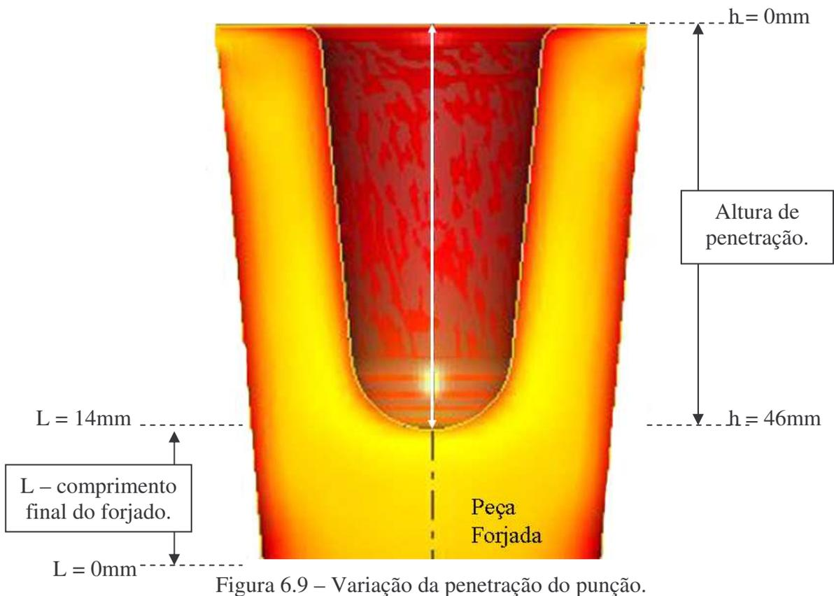
Figura 6.9 – Variação da penetração do punção.
