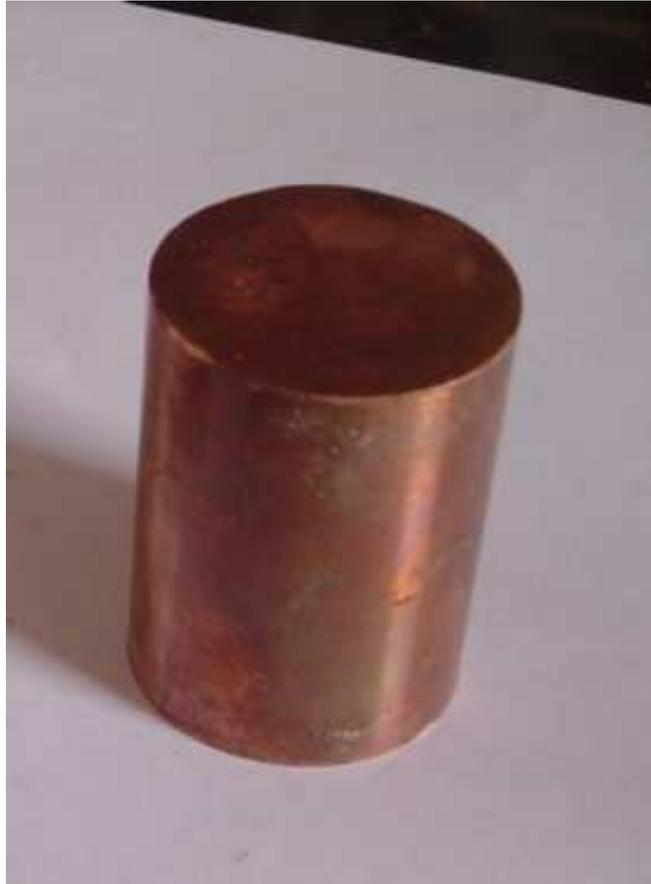
Figura 4.12 - Peça cilíndrica com diâmetro de 38,1mm, altura de 56mm e com volume de 63845mm<sup>3</sup>.
