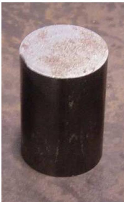
Figura 3.3 – Peça cilíndrica de aço AISI 8640 para início do processo de usinagem com altura de 62mm, diâmetro de 38,1mm e volume de 70685mm<sup>3</sup>.
