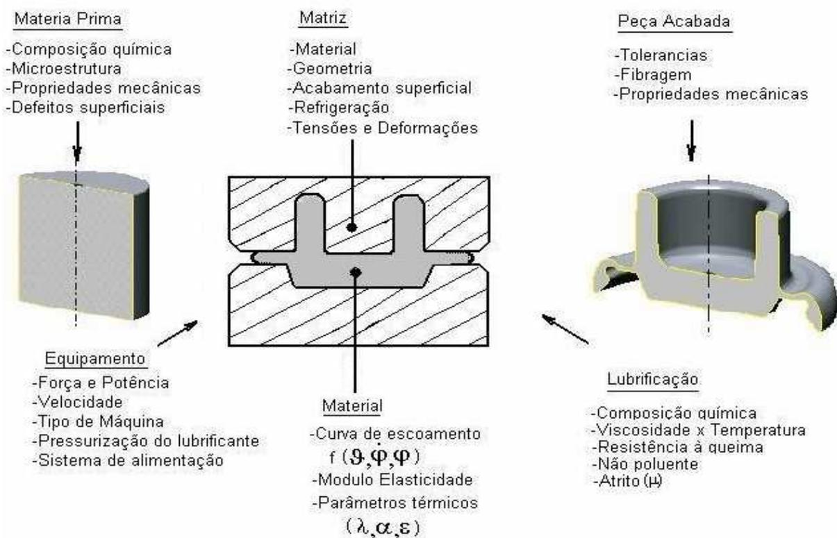
Figura 2.1 – Principais parâmetros envolvidos no processo de forjamento [2].
