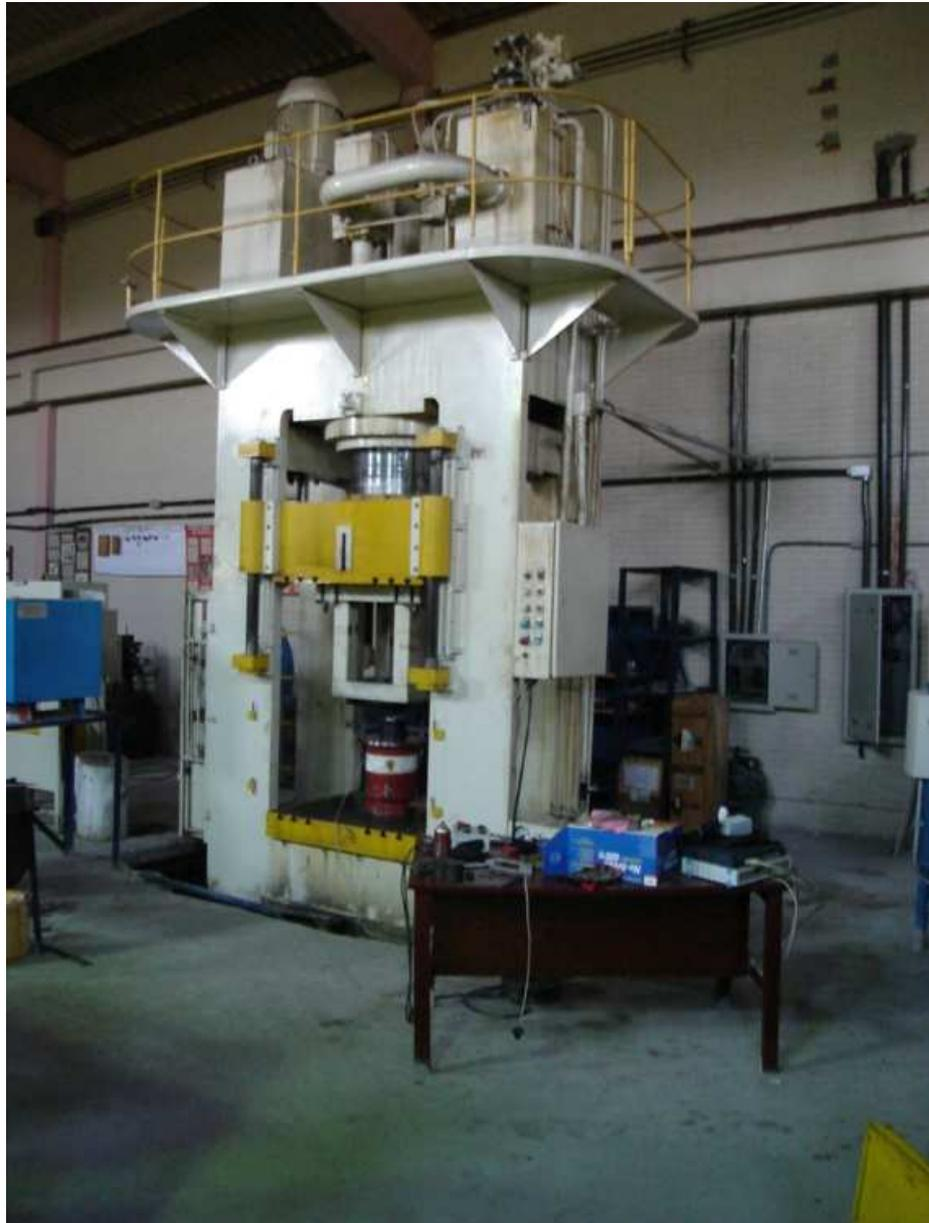
Figura 5.7 – Prensa hidráulica de 7350 kN utilizada no LdTM para forjamento da pré-forma.
