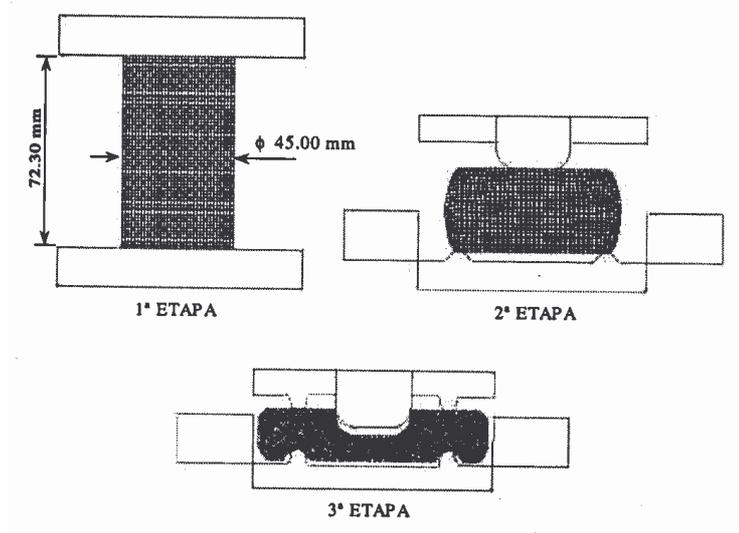
Figura 2.17 – Sequência de etapas para o forjamento do componente [28].
