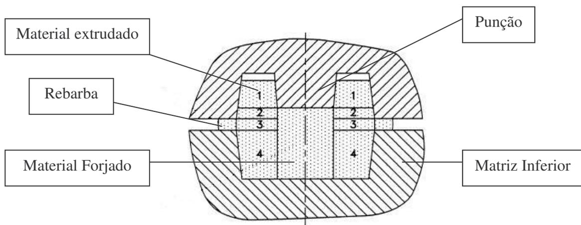
Figura 2.23 – Divisão da zona de conformação em regiões [16].
