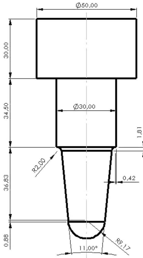
Figura 4.6 – Desenho com vista lateral do punção.
