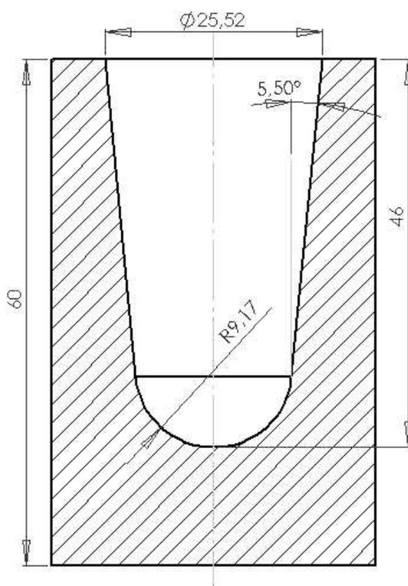
Figura 4.1 – Desenho do perfil da pré-forma.
