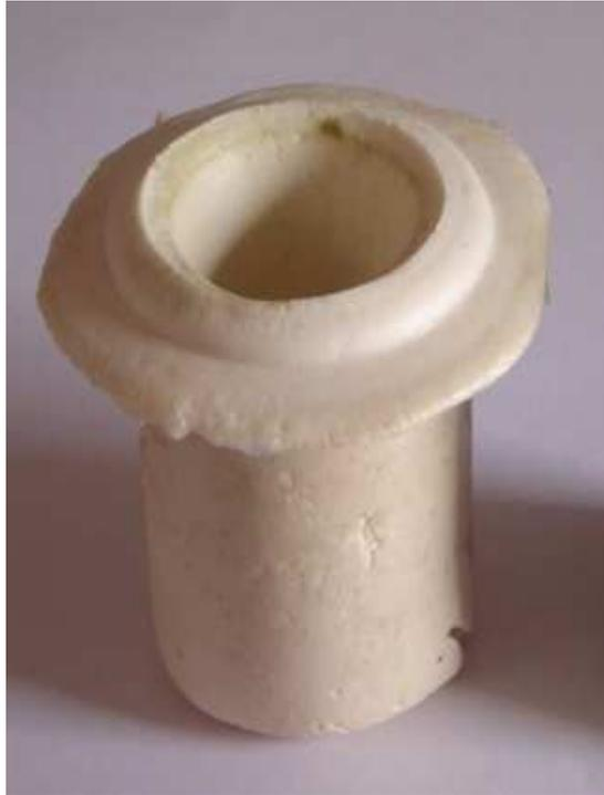
Figura 4.10 – Peça de plasticina forjada com altura inicial de 60mm, diâmetro de 38,1mm, mostrando a formação de rebarba com volume de 68405mm<sup>3</sup>.
