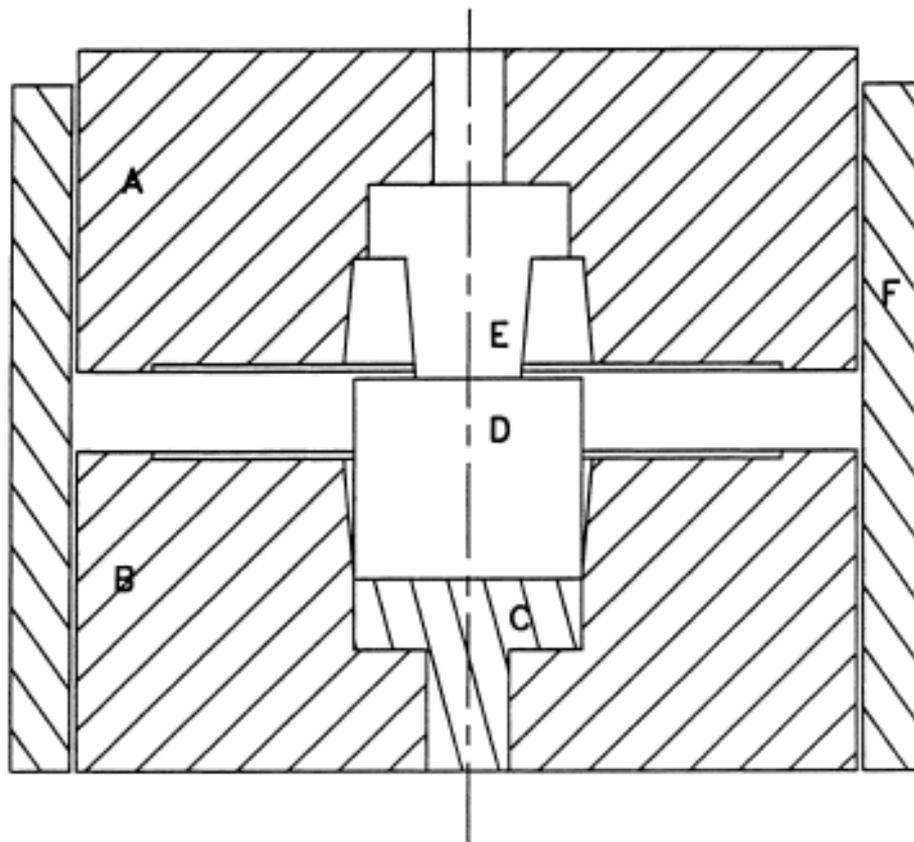
Figura 2.5 – Processo de extrusão indireta (Componente A: Matriz superior; Componente B: Matriz inferior; Componente C: Extrator; Componente D: *Billet*; Componente E: Punção) [16].
