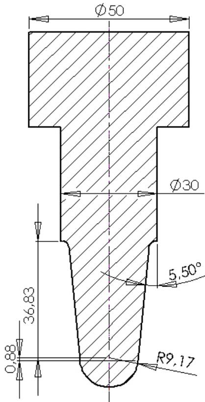
Figura 5.3 – Vista lateral em corte do punção.
