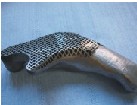
Figura 52 - Protótipo após ser removido da plataforma. A estrutura suporte deve ser removida na etapa de acabamento.
