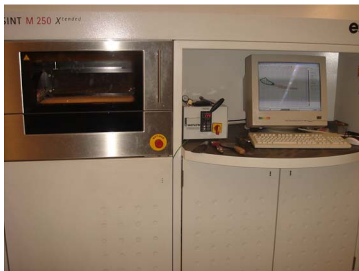
Figura 15 - Equipamento de EOS utilizado para metais: Direct Metal Laser Sintering (DMLS). Fonte: equipamento instalado nas dependências do Instituto Fraunhofer IFAM, Alemanha.
