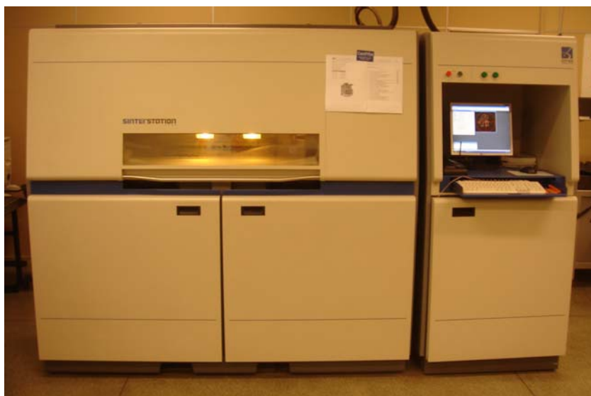
Figura 12 - Equipamento SLS instalado nas dependências do Cenpra/ Campinas.
