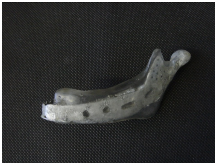
Figura 41 - Protótipo da prótese de mandíbula constituído de estrutura metálica, resina epóxi e resina poliéster.
