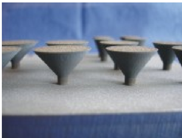
Figura 54 – Corpos-de-prova produzidos para investigar a influência do ângulo de inclinação do modelo em relação à plataforma.
