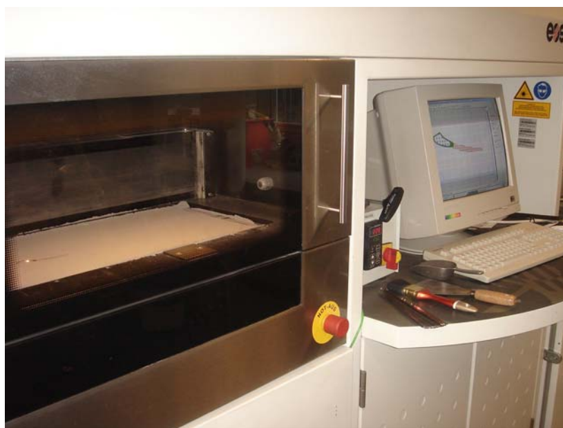
Figura 26 - Equipamento de sinterização a laser modelo EOSINT M 250X. Fonte: Equipamento instalado nas dependências do Instituto Fraunhofer IFAM, Alemanha.
