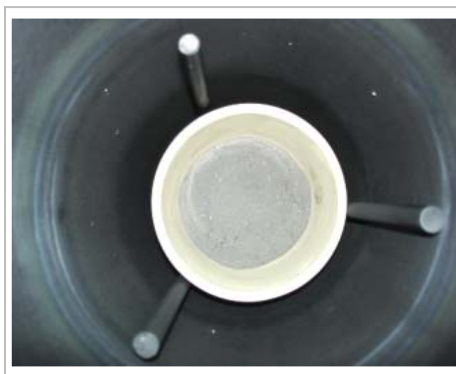
Figura 18 Detalhe do interior do forno com o cadinho e a carga metálica.
