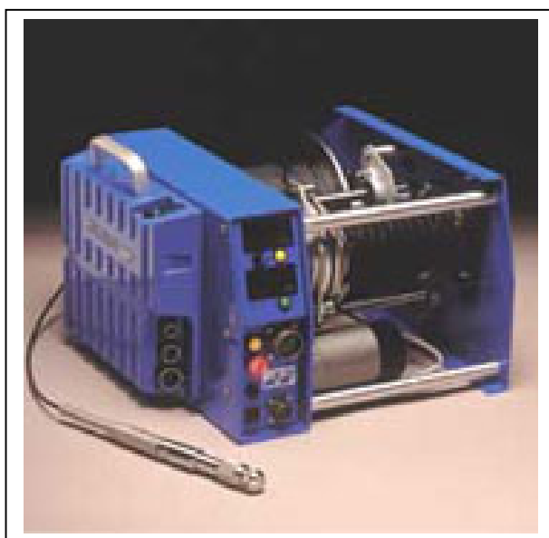
Figura A.3 - Foto do guincho com a unidade aquisição encaixada.
