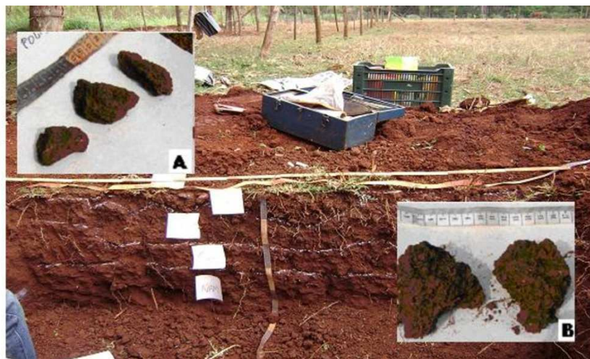
Figura 17 - Estruturas do solo sob manejo da pastagem. A: prismática, B: blocos angulares a subangulares
