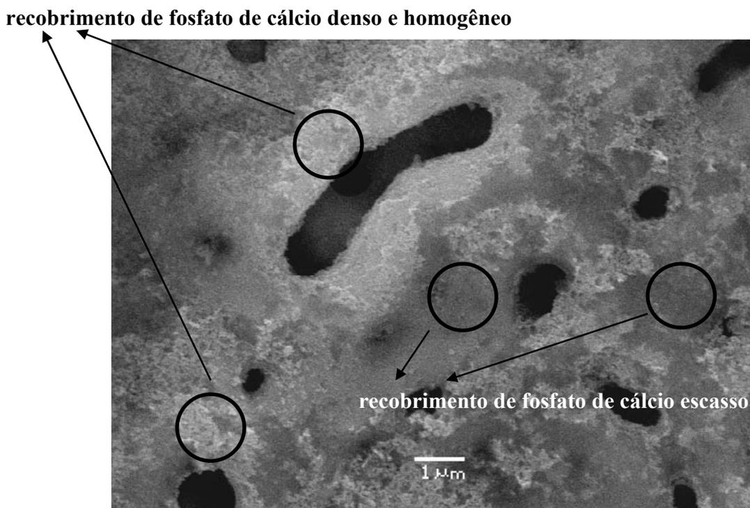
Figura 5.25 Micrografia, em vista de topo, apresentando uma grande quantidade de deposição de fosfatos de cálcio em torno de uma trilha do óxido anódico de Ti.
