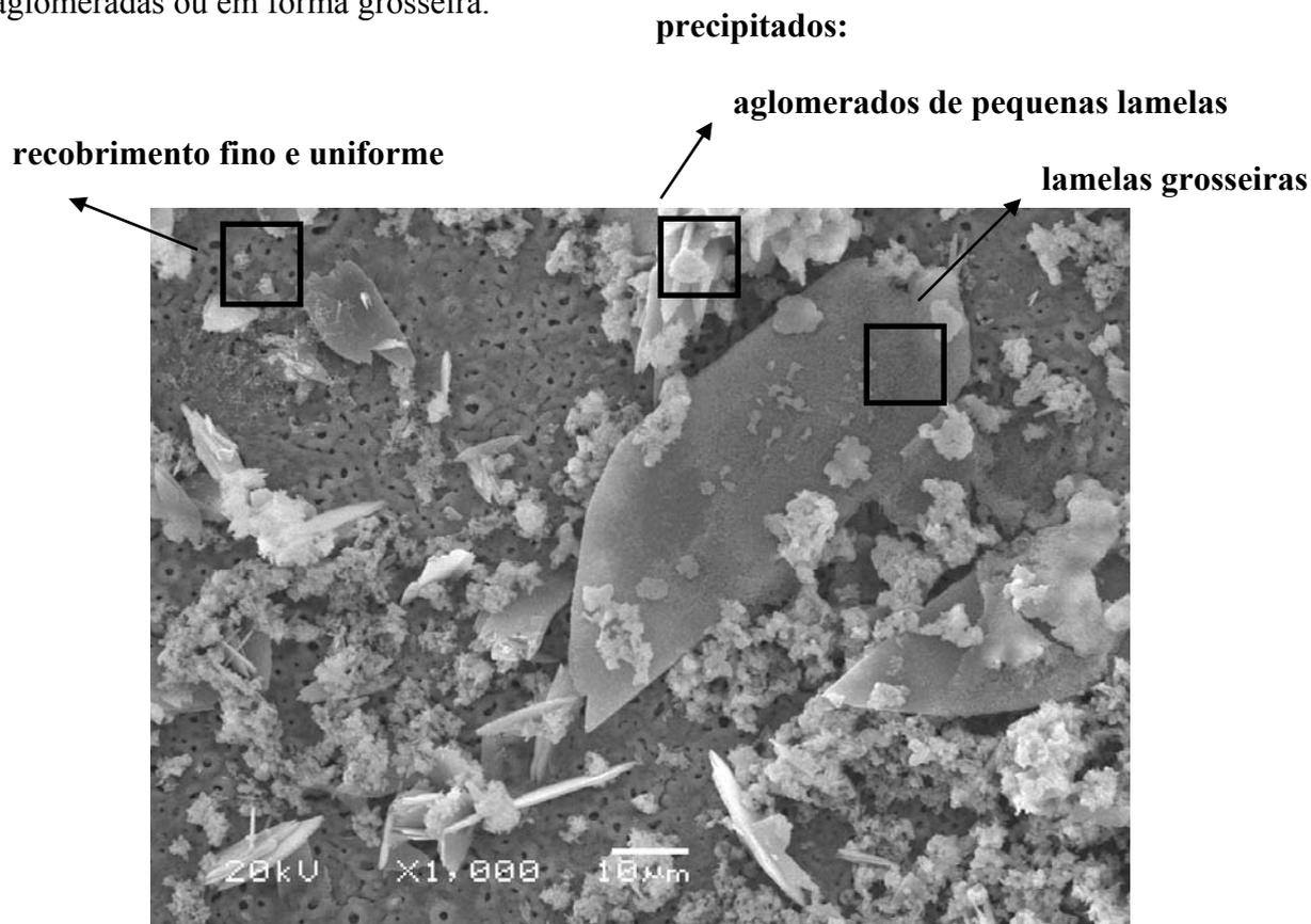
Figura 5.24 Micrografia, em vista de topo, apresentando as morfologias formadas pela deposição química de fosfato de cálcio, através de ciclos de imersão em solução de fosfatos de cálcio em suspensão e posterior imersão em solução com suspensão de Ca(OH)<sub>2</sub>, sobre Ti anodizado.
