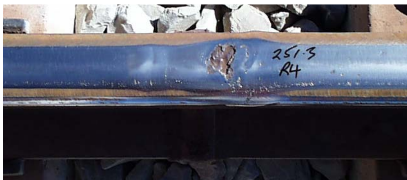
Figura 2.25 – Aspecto visual do defeito canoa (DUVEL, 2005).
