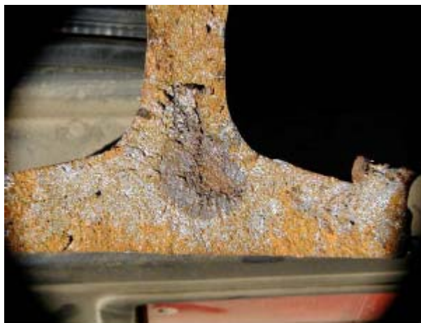
Figura 2.19 – Contração da solda na região entre a alma e o patim (WTIA, 2006).
