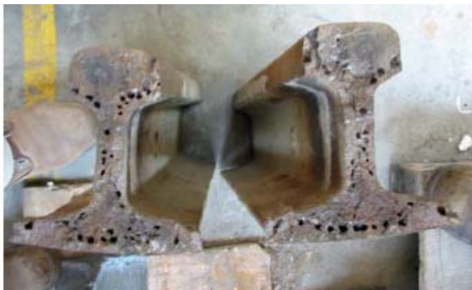
Figura 2.24 – Soldas com forte porosidade (WTIA, 2006).
