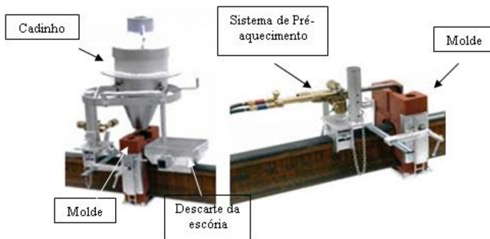
Figura 2.12 – Equipamentos utilizados na soldagem aluminotérmica. (KLL)
