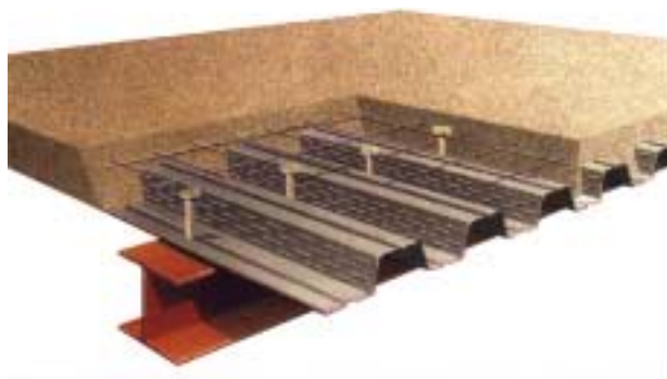
Figura 2.11 - Vedação horizontal com Steel Deck
