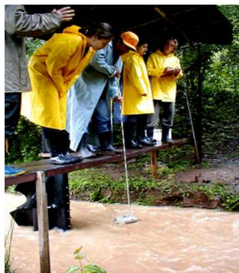
Figura 3.11: Coleta de sedimentos em suspensão através de amostrador USDH-48.
