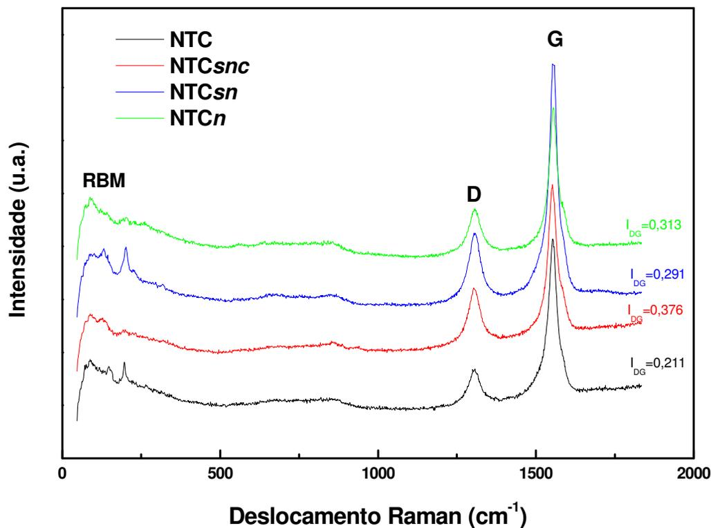
**Figura 6.3:** Espectro Raman de NTC funcionalizados com diferentes ácidos, comparados com NTCs não funcionalizados.
