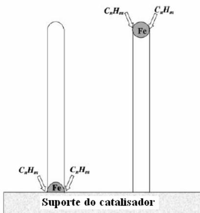
**Figura 4.6:** Crescimento dos NTCs pelo método CVD (DRESSELHAUS, 2001).
