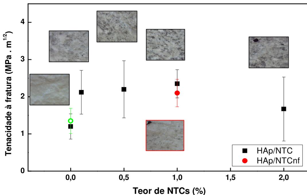
**Figura 6.10:** Valores obtidos para a tenacidade à fratura dos compósitos HAp/NTC a partir do ensaio mecânico de compressão. Micrografias obtidas por microscopia óptica da face de fratura (Aumento de 50x).
