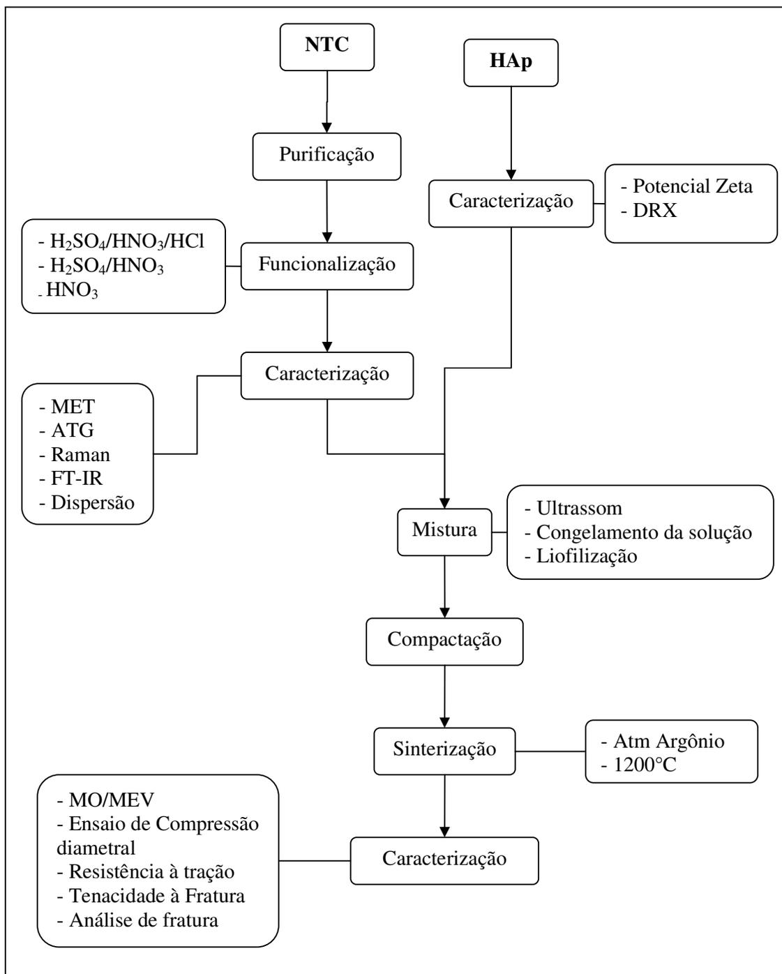
**Figura 5.1:** Fluxograma do procedimento experimental adotado neste trabalho.
