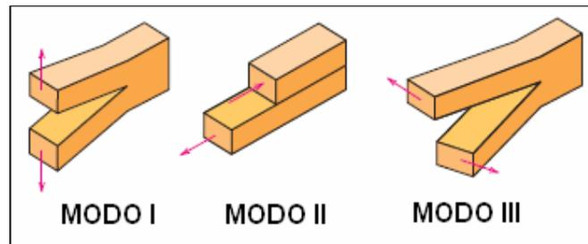
**Figura 4.8:** Modos de concentração de tensões (RICHERSON, 1992).
