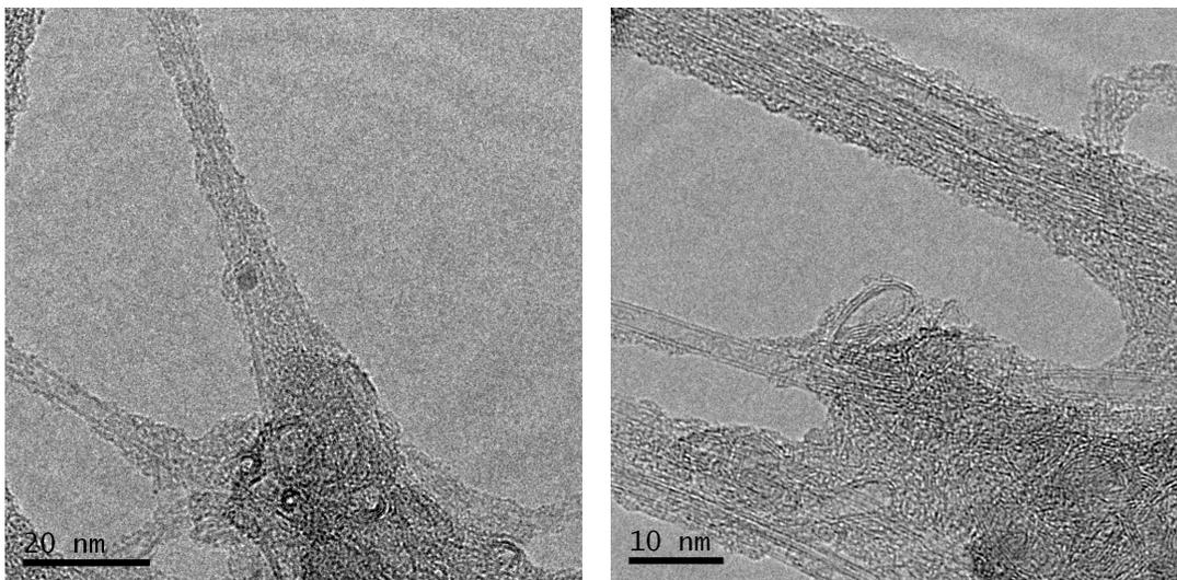
**Figura 6.2:** Micrografia de NTCs funcionalizados (NTC<sub>sn</sub>) obtidas por MET.
