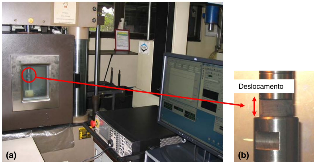
Figura 4.8 – Equipamento MTS 810-Flex Test e atuador mecânico em câmara climatizada (a). Detalhe do atuador com corpo-de-prova fixado no dispositivo de teste (b).
