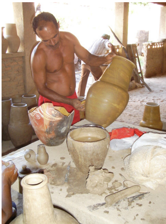
Figura 53: O ceramista Regino de Albuquerque Araújo aplicando tauá no bojo do pote no ano de 2007 na sede da Associação em Barra. Foto: Carla Costa
