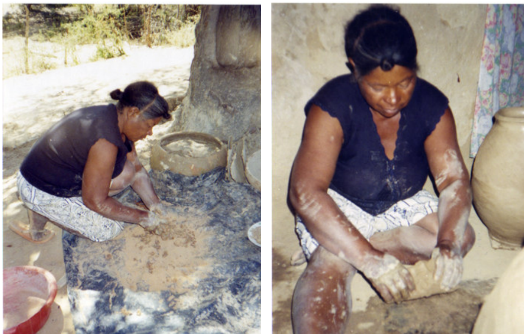
Figura 66: Mistura da pasta de argila e início da modelagem. Povoado de Nova União, em 2003. Foto: Carla Costa
