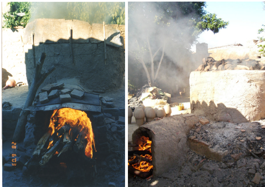
Figura 38 "Buchada", momento durante a queima em que as peças ficam limpas, a foto à esquerda em 2003 e à direita em 2007. Foto: Carla Costa
