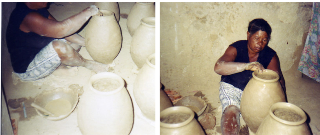
Figura 70: Início da Modelagem do beijo do pote e uso do alforje para alisar o beijo. Foto: Carla Costa
