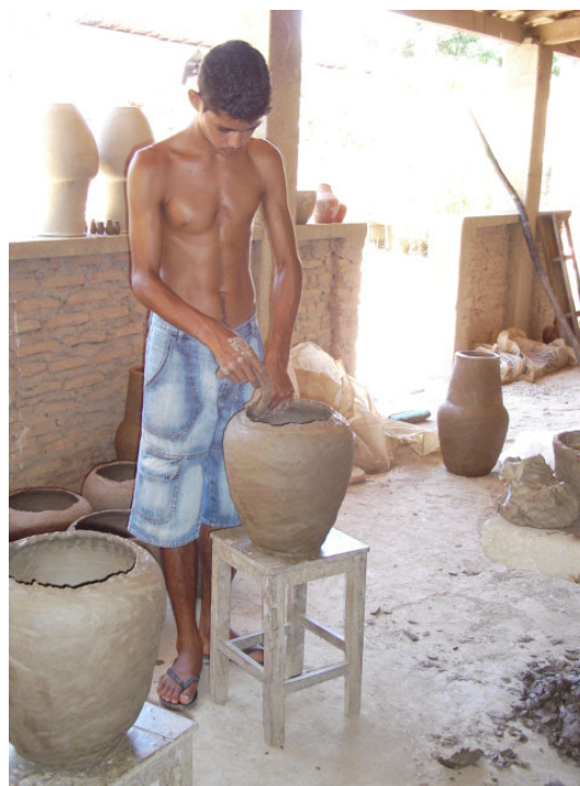
Figura 43: Moisés Cruz Ferreira aplica o rolete onde será inserido o pescoço do pote no ano de 2007 na sede da Associação em Barra. Foto: Carla Costa
