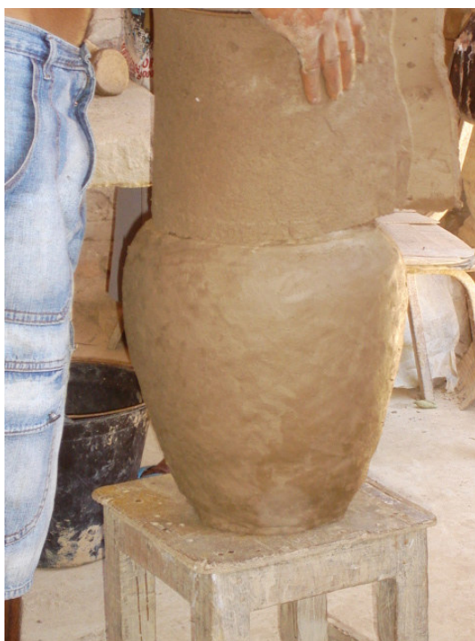
Figura 45: Aplicação da placa de barro para modelar o gargalo do pote no ano de 2007 na sede da Associação em Barra. Foto: Carla Costa
