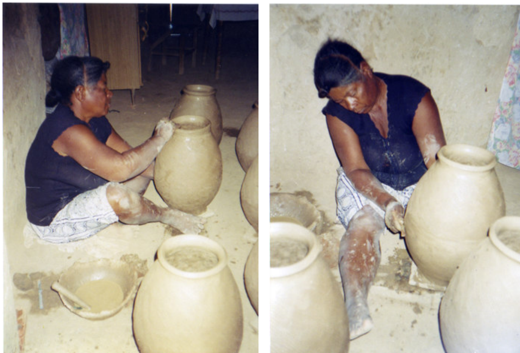
Figura 71: Alisamento da boca do pote e uso da costela sobre a superfície do pote. Foto: Carla Costa
