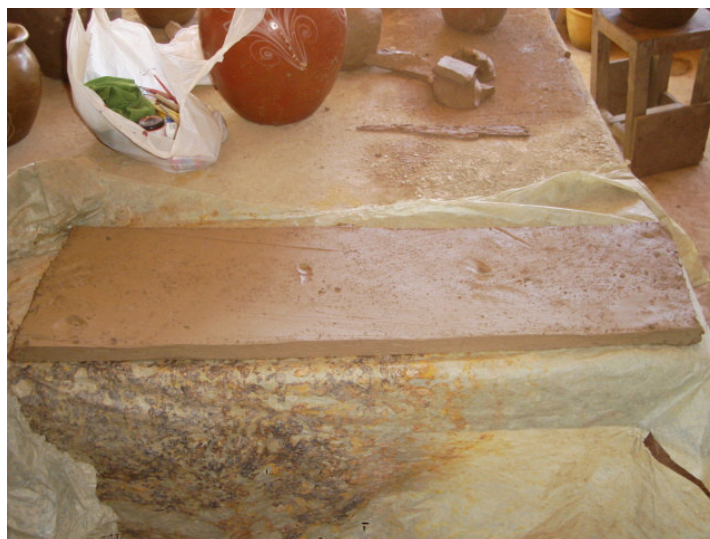
Figura 44: Placa de barro utilizada para produzir o gargalo do pote no ano de 2007 na sede da Associação em Barra. Foto: Carla Costa
