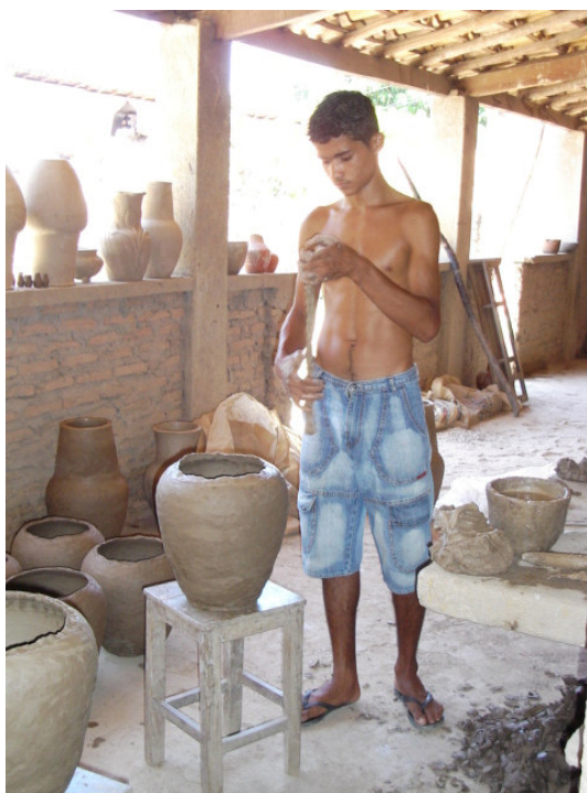
Figura 42: O ceramista Moisés Cruz Ferreira utilizando a técnica do acordelamento no ano de 2007 na sede da Associação em Barra. Foto: Carla Costa
