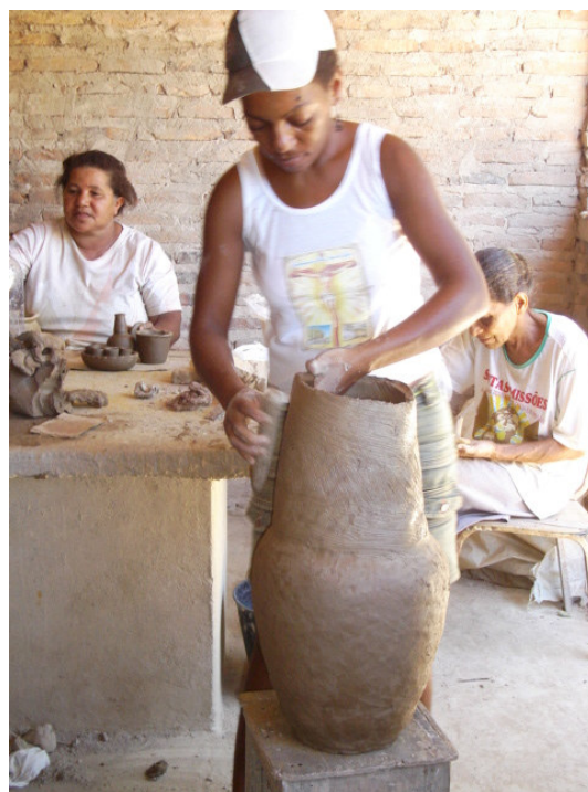
Figura 48 e 49: Uso do cascabulho de milho para acertar as lombadas e garantir firmeza ao gargalo do pote no ano de 2007 na sede da Associação em Barra. Foto: Carla Costa
