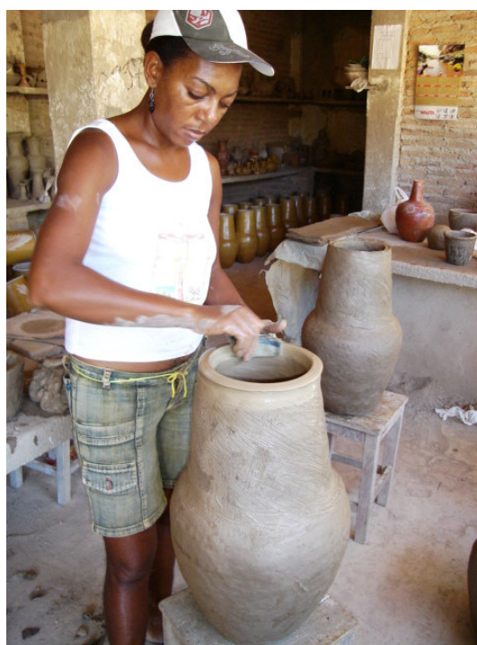
Figura 52: A ceramista Leonor utiliza pedaço de jeans para virar o beijo do pote no ano de 2007 na sede da Associação em Barra. Foto: Carla Costa
