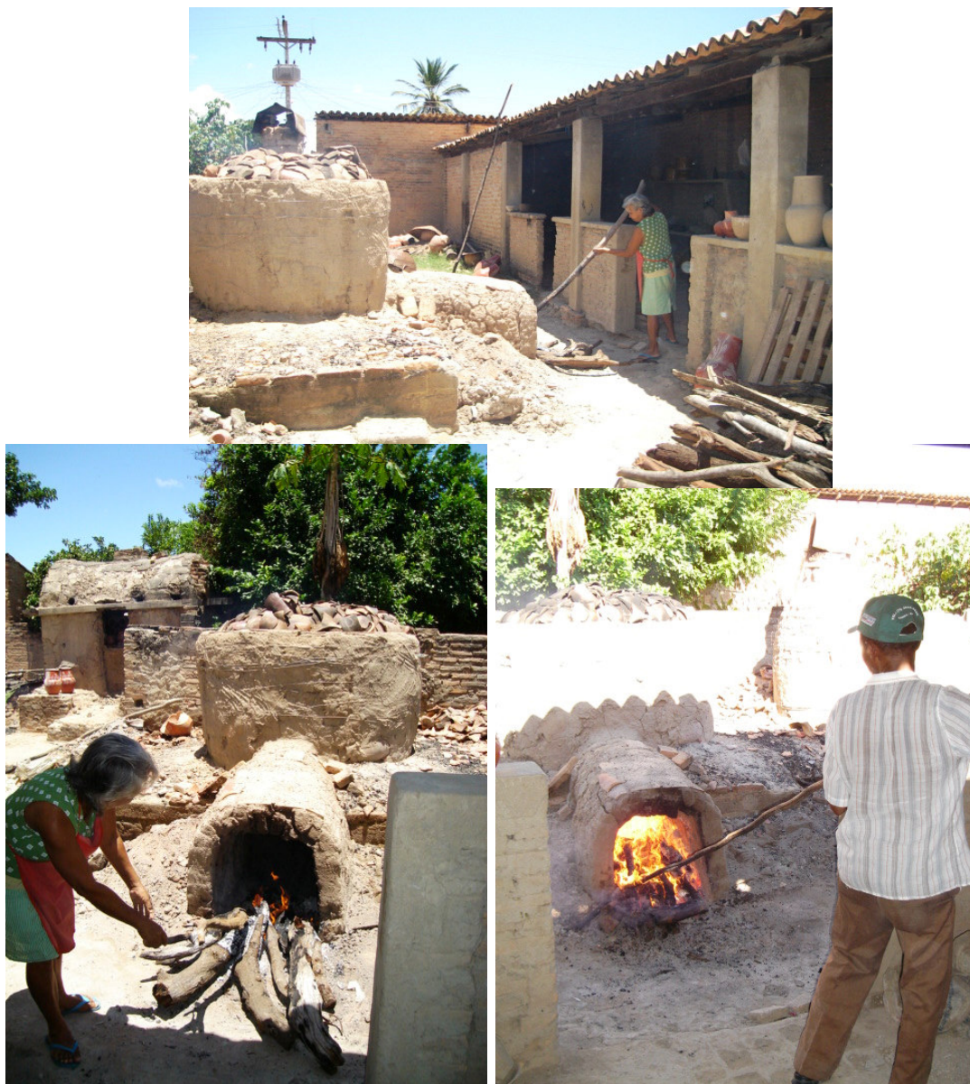
Figura 39 Controle da queima da cerâmica em forno sertanejo, em fev. 2007. Foto: Carla Costa
