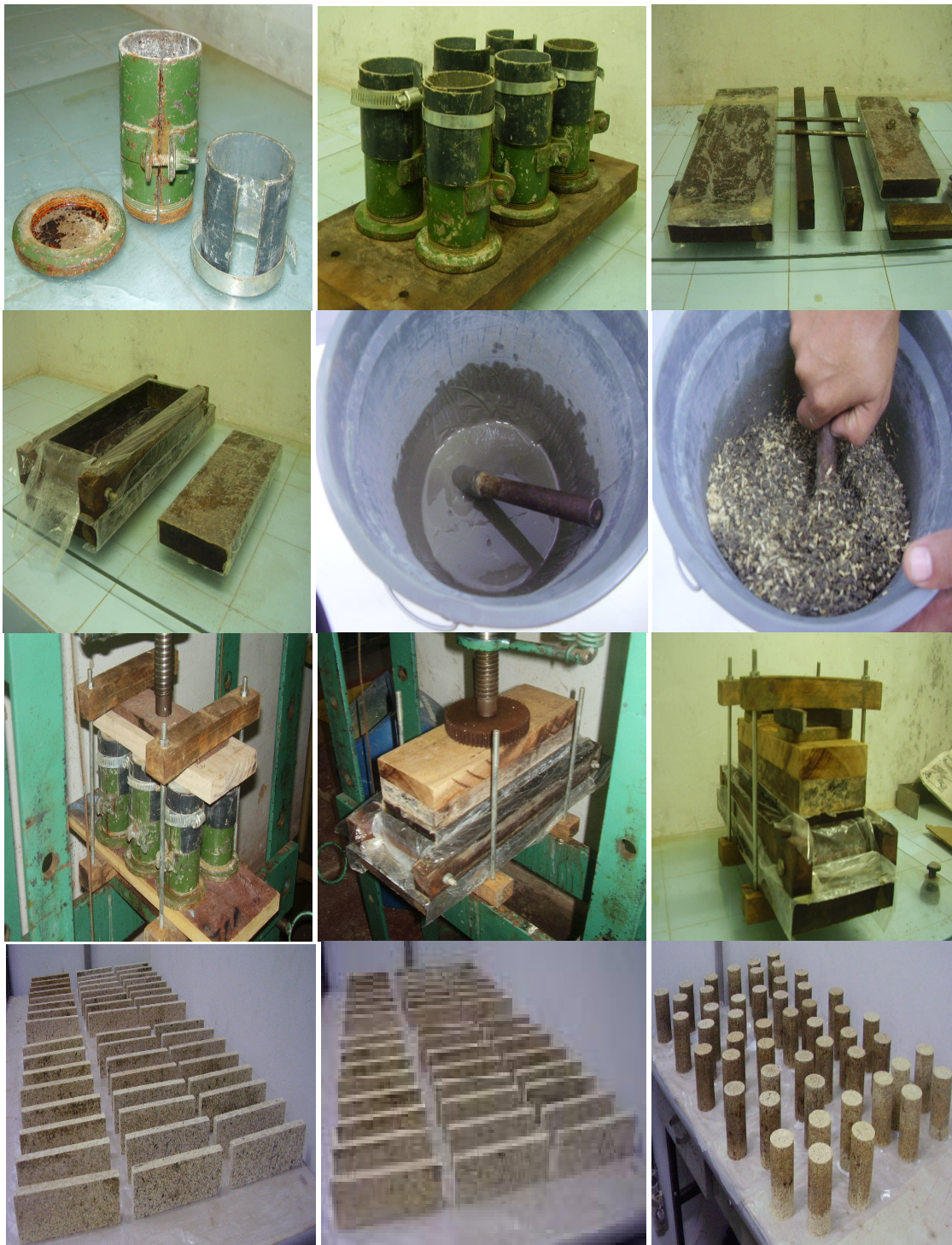
Figura 3.3 Etapas do processo de moldagem e cura dos corpos de prova.
