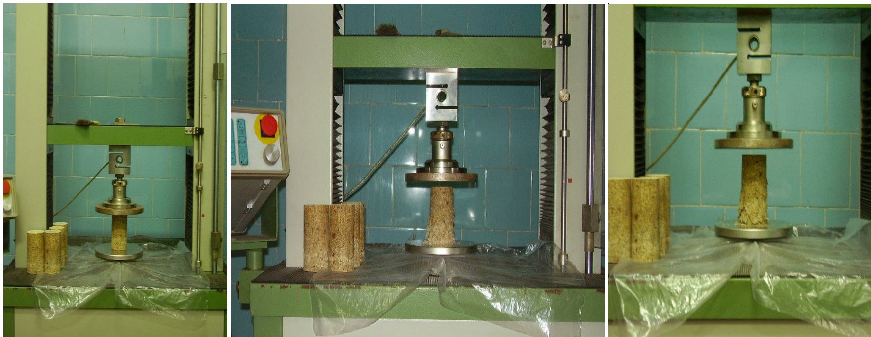
Figura D1 Rompimento de corpos de prova em compressão.
