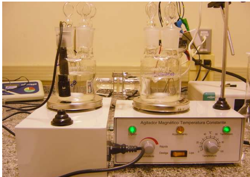
Figura 12: Célula compartimentada para medidas de fluxo iônico por condutimetria. À esquerda o compartimento hipotônico.
