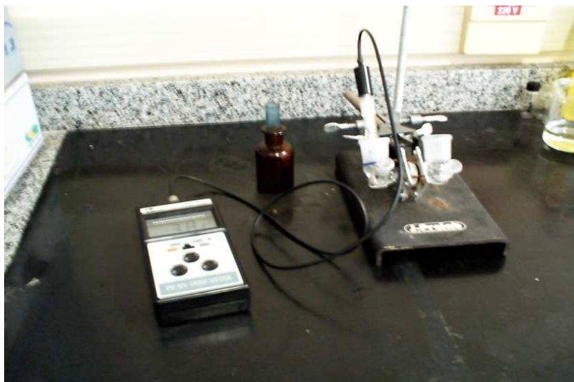
Figura 11: Célula compartimentada pequena para medidas de fluxo de prótons.
