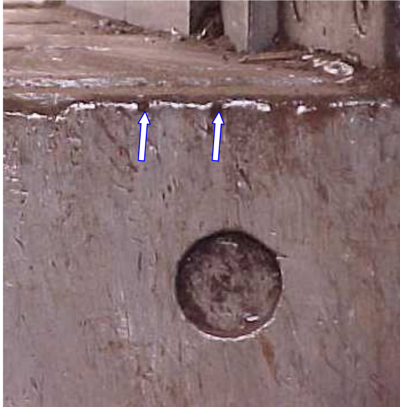
Figura 4.12: Navalha de aço S1 com pequenas quebras na aresta de corte.
