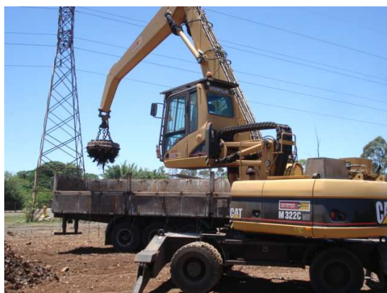
Figura 2.6: Descarga de sucata com a utilização de implemento do tipo eletroímã.
