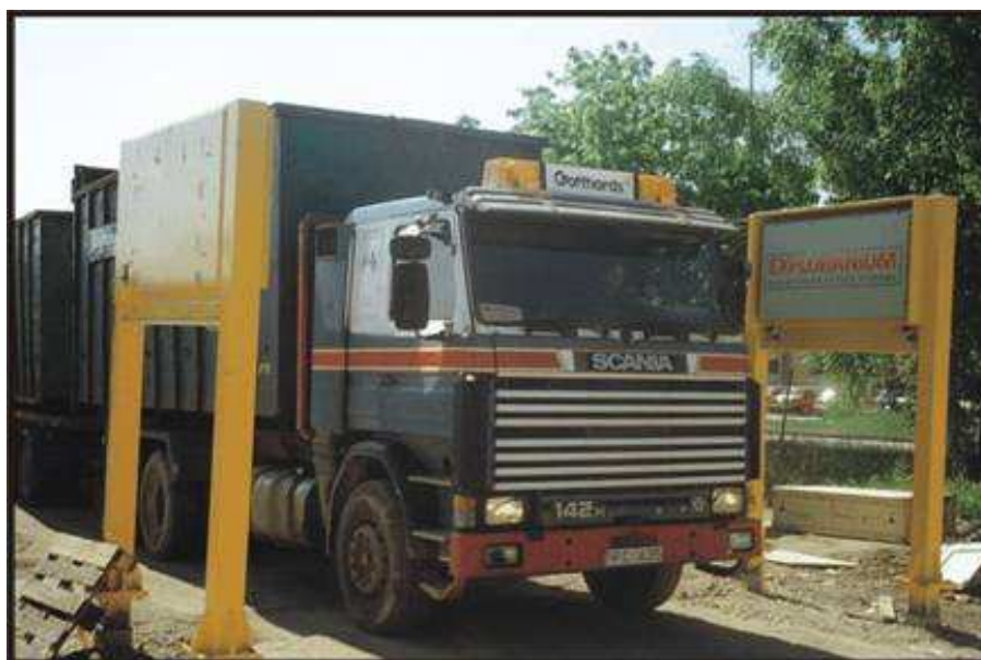
Figura 2.3: Monitoramento de fontes radioativas na sucata.
