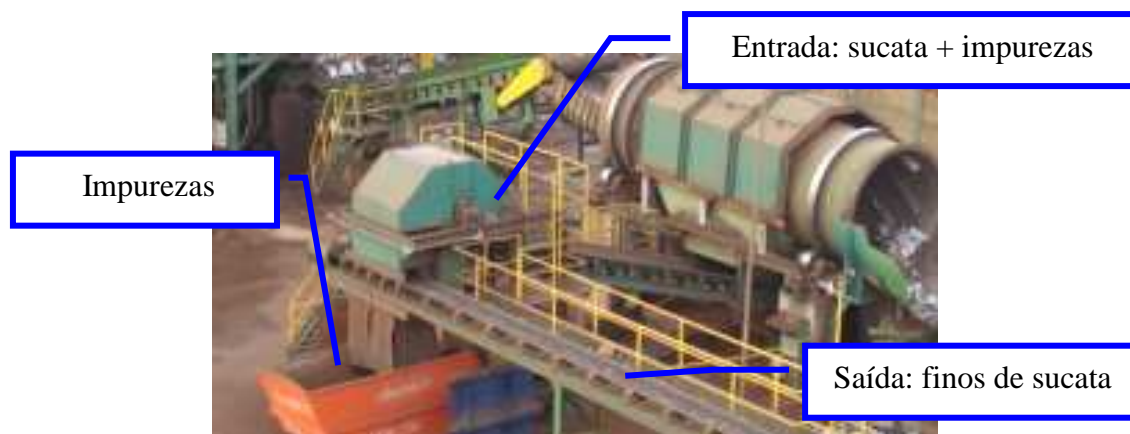
Figura 1.7: Separação magnética dos finos de sucata remanescentes do tamboramento.
