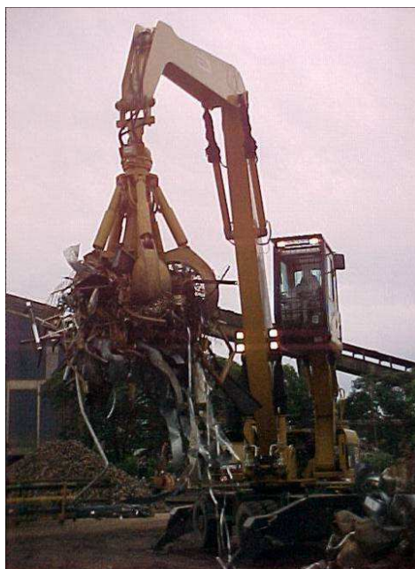
Figura 2.5: Descarga de sucata com a utilização de implemento do tipo garra.
