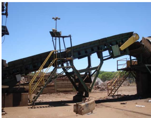
Figura 1.5: Transporte da sucata já cortada até o tambor rotativo.
