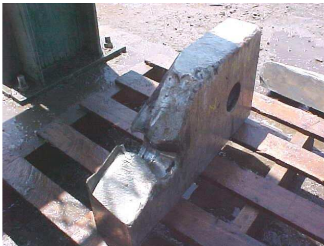
Figura 4.1: Par de navalhas C do aço AISI S1 após 4 h de operação.
