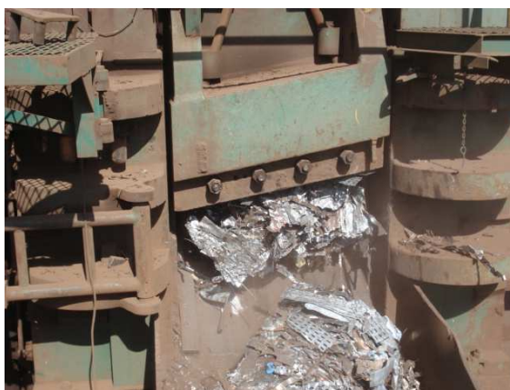
Figura 1.4: Corte da sucata pelas navalhas da prensa tesoura.
