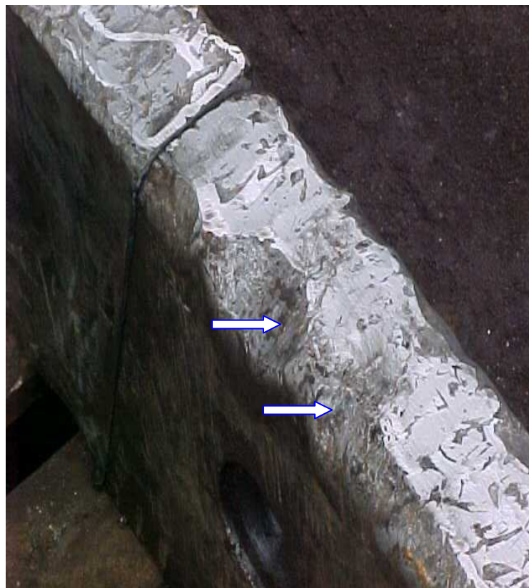
Figura 4.13: Navalha de aço SAE 4340 com grandes depressões na aresta de corte (vista superior).
