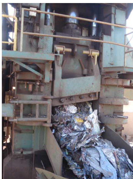
Figura 1.3: Compactação da sucata previamente ao seu corte.
