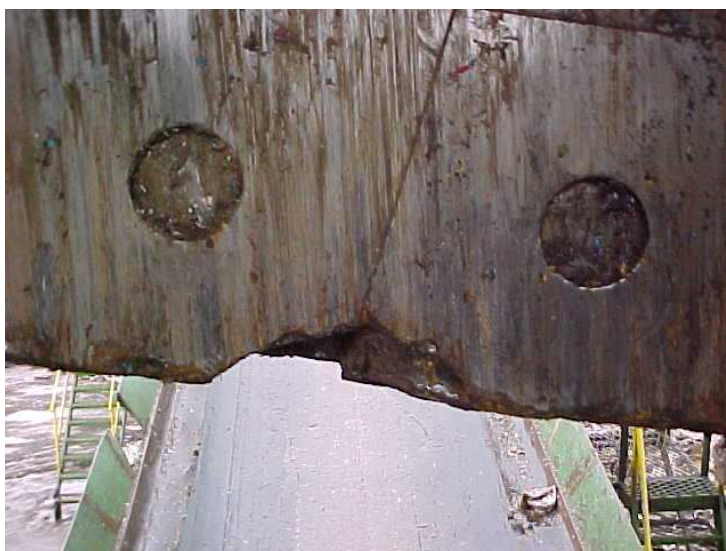
Figura 4.2: Par de navalhas G do aço AISI S1 após 6 h de operação.
