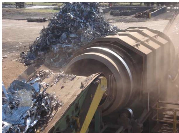
Figura 1.6: Remoção das impurezas da sucata no tambor rotativo.
