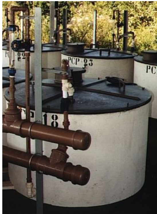
Figura 3: Biorreatores com sistema de aeração forçada para tratamento de 400 Kg de solo por unidade Foto: Ricardo R. da Silva.
