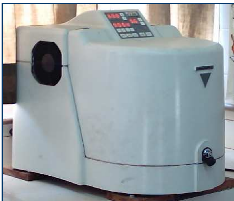
Figura 4.2: Moinho de bolas utilizado (marca Fritsch, modelo Pulverisette 6).
