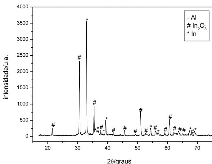
Figura 30: Difratograma de raios X do sistema 7 [ $\text{SnO}_2\text{:C}$  (1:1,5) e  $\text{In}_2\text{O}_3\text{:C}$  (1:1,5)].
