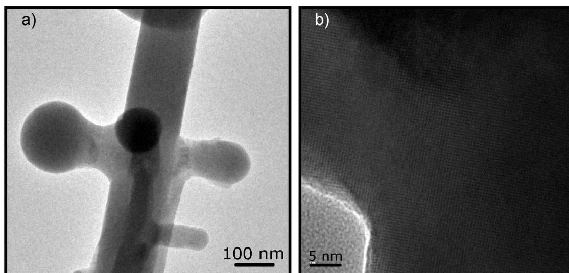
Figura 40: a) Imagem de MET de uma nanofita com uma dendrite. b) Imagem de HRTEM da junção da nanofita com a dendrite.
