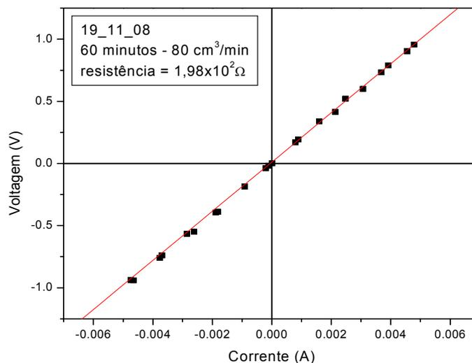
Figura 73: Gráfico da voltagem x corrente das nanoestruturas obtidas na síntese com fluxo de nitrogênio de  $80 \text{ cm}^3/\text{min}$ .
