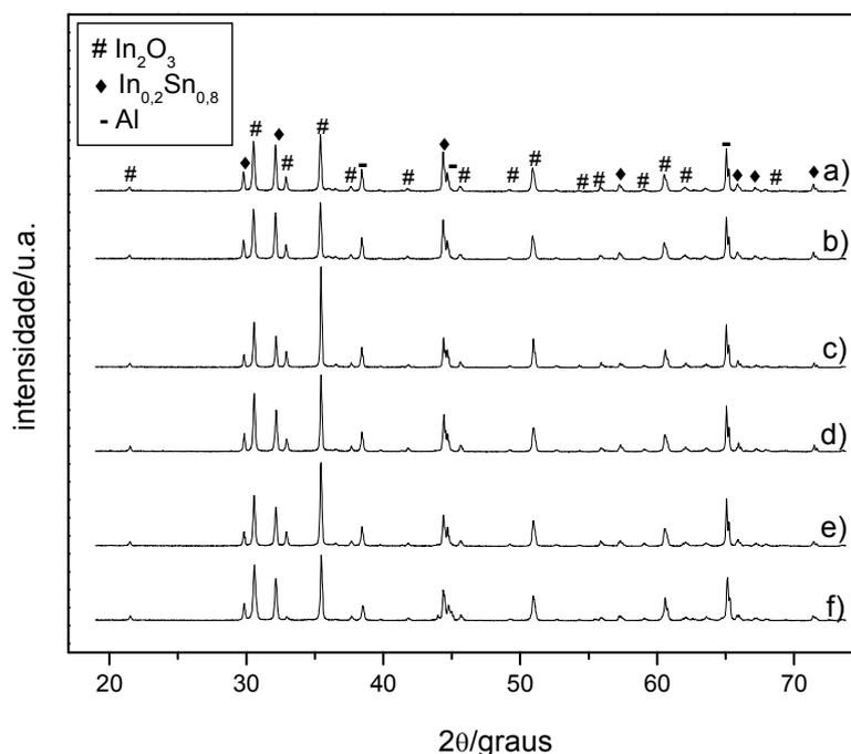
Figura 65: Difratogramas de raios X das sínteses referentes as seguintes vazões de fluxo de nitrogênio: a) 160 cm<sup>3</sup>/minutos, b) 120 cm<sup>3</sup>/minutos, c) 80 cm<sup>3</sup>/minutos, d) 60 cm<sup>3</sup>/minutos, e) 40 cm<sup>3</sup>/minutos, f) 20 cm<sup>3</sup>/minutos.
