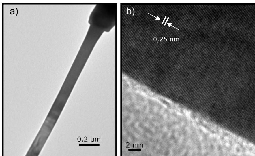
Figura 55: a-b) Imagens de MET e de HRTEM de uma nanofita da síntese de 60 minutos de patamar.
