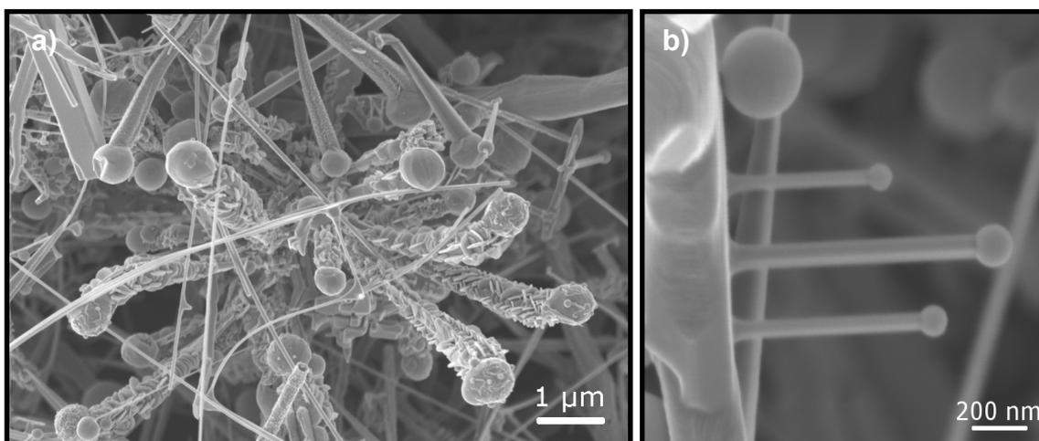
Figura 15: a-b) Imagens de MEV do material referente ao sistema 2 [ $\text{SnO}_2\text{:C}$  (1,5:1) e  $\text{In}_2\text{O}_3\text{:C}$  (1:1)].
