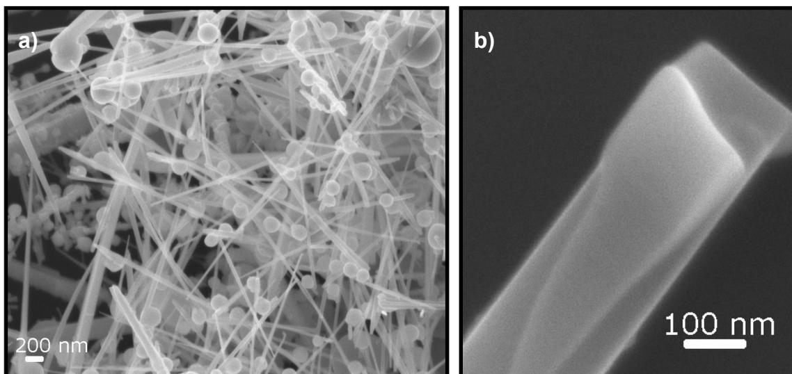
Figura 74: a-b) Imagens de MEV das nanoestruturas obtidas na síntese com vazão de fluxo de nitrogênio de  $60 \text{ cm}^3/\text{min}$ .
