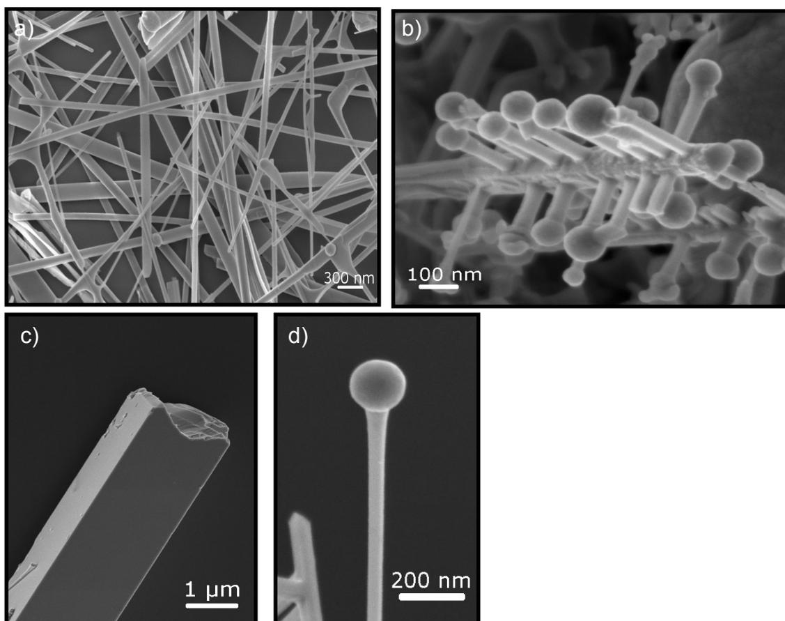
Figura 37: a-b-c-d) Imagens de MEV do material referente ao sistema 9 [ $\text{SnO}_2\text{:C}$  (1:1,5) e  $\text{In}_2\text{O}_3\text{:C}$  (1,5:1)]
