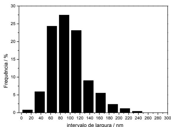
Figura 63: Histograma da distribuição de larguras das nanoestruturas obtidas na síntese com tempo de patamar de 15 minutos.
