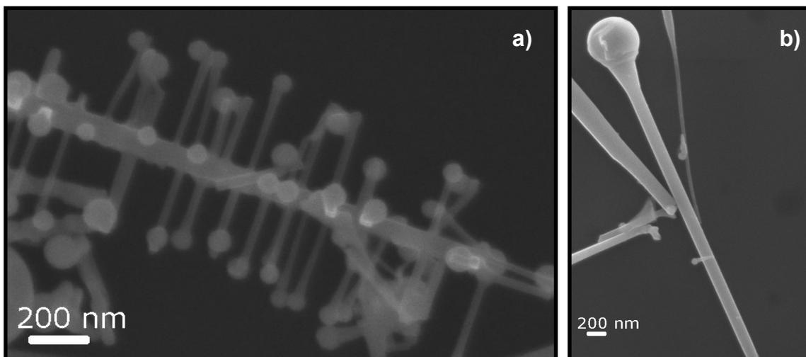
Figura 77: a-b) Imagem de MEV de nanoestruturas obtidas na síntese com vazão de fluxo de nitrogênio de  $20 \text{ cm}^3/\text{min}$ .
