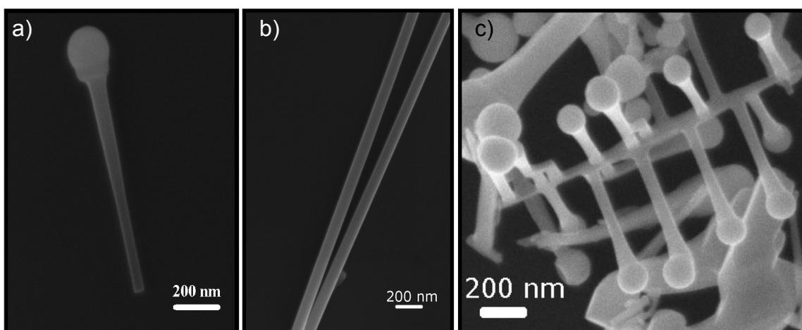
Figura 45: a-b-c) Imagens de MEV do material obtido da síntese com 120 minutos de patamar.
