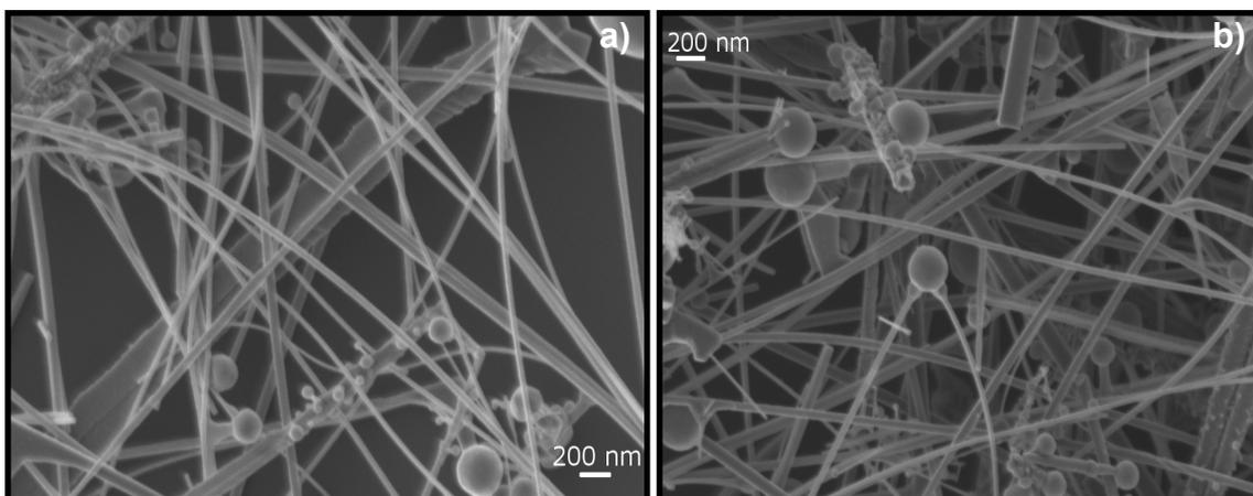
Figura 34: a-b) Imagens de MEV do material referente ao sistema 8 [ $\text{SnO}_2\text{:C}$  (1,5:1) e  $\text{In}_2\text{O}_3\text{:C}$  (1:1,5)].
