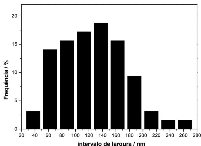
Figura 16: Histograma da distribuição de larguras das nanoestruturas do sistema 2 [SnO<sub>2</sub>:C (1,5:1) e In<sub>2</sub>O<sub>3</sub>:C (1:1)].
