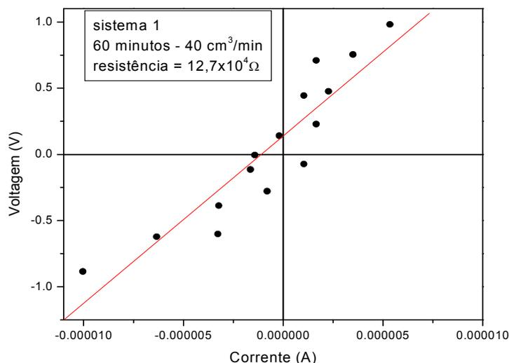
Figura 57: Gráfico de tensão x corrente da nanoestrutura obtida na síntese com patamar de 60 minutos.
