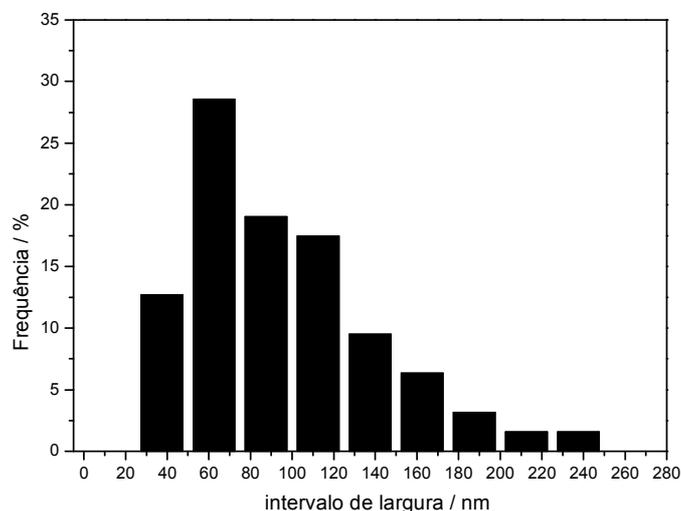
Figura 61: Histograma da distribuição de larguras das nanoestruturas obtidas na síntese de 30 minutos.
