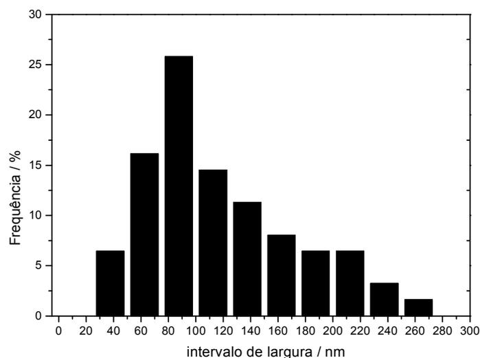
Figura 76: Histograma da distribuição de larguras das nanoestruturas obtidas na síntese com vazão de fluxo de nitrogênio de  $60 \text{ cm}^3/\text{min}$ .
