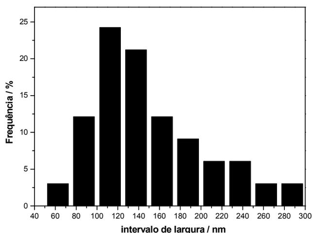
Figura 32: Histograma da distribuição de larguras das nanoestruturas do sistema 7 [ $\text{SnO}_2\text{:C}$  (1:1,5) e  $\text{In}_2\text{O}_3\text{:C}$  (1:1,5)].
