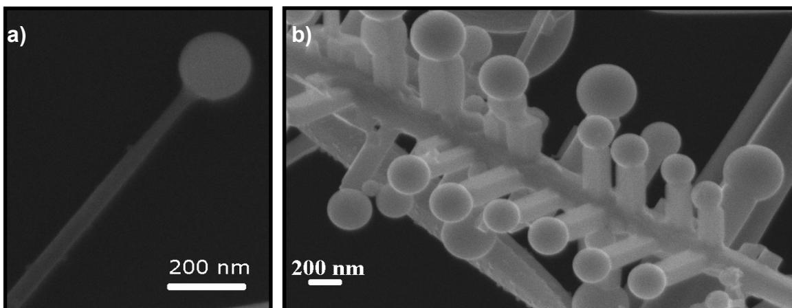
Figura 51: a-b) Imagens de MEV das nanoestruturas obtidas na síntese com patamar de 75 minutos.
