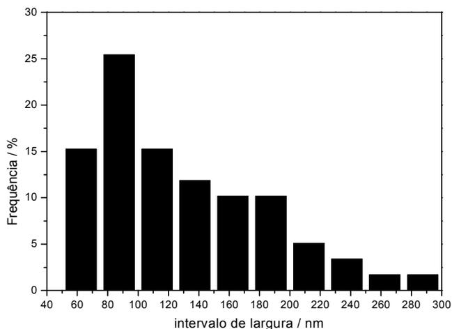
Figura 50: Histograma da distribuição de larguras das nanoestruturas obtidas na síntese com 90 minutos de patamar.
