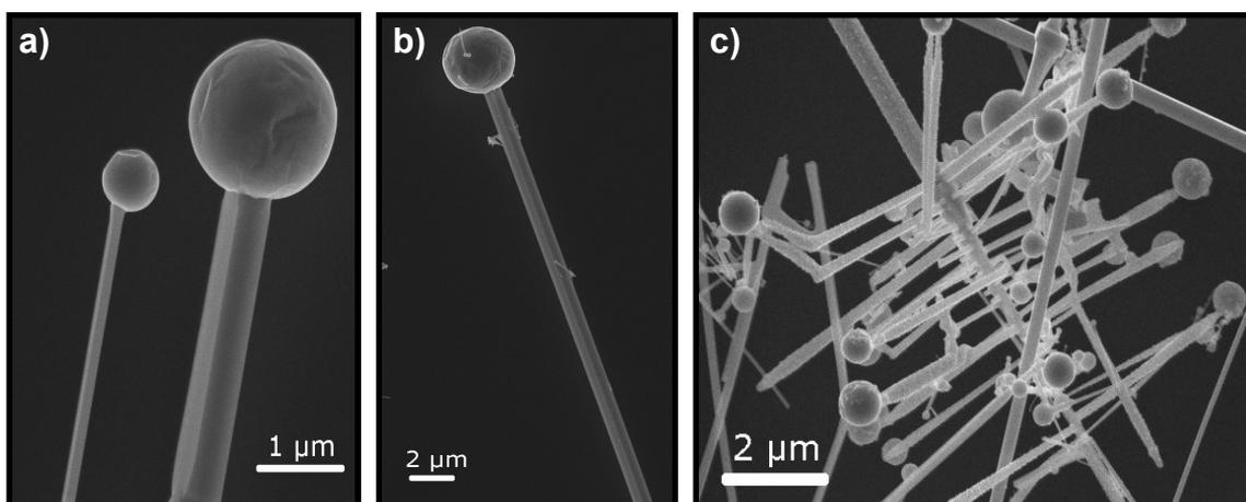
Figura 49: a-b-c) Imagens de MEV ilustrando nanofitas obtidas na síntese com 90 minutos de patamar.
