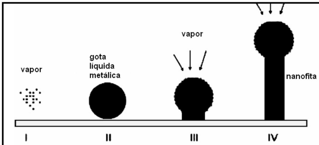
Figura 1: Esquema do mecanismo de crescimento por vapor-líquido-sólido (VLS) de nanofitas.
