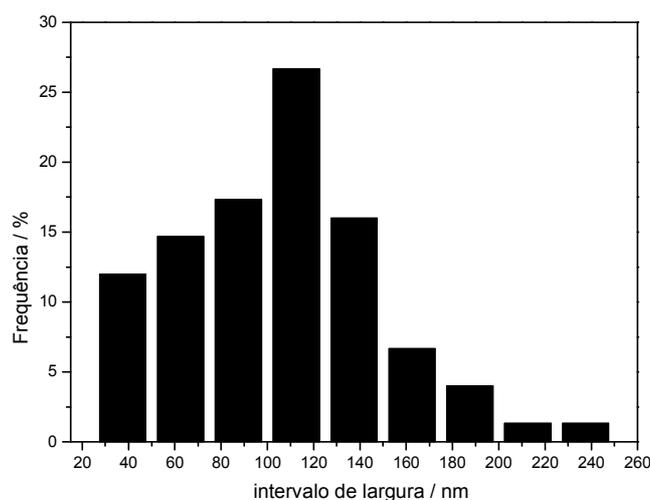
Figura 72: Histograma da distribuição de larguras das nanoestruturas obtidas na síntese com vazão de fluxo de nitrogênio de 80 cm<sup>3</sup>/min.
