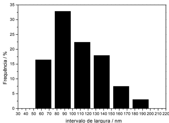
Figura 69: Histograma da distribuição de larguras das nanoestruturas obtidas na síntese com vazão de fluxo de nitrogênio de  $120 \text{ cm}^3/\text{min}$ .
