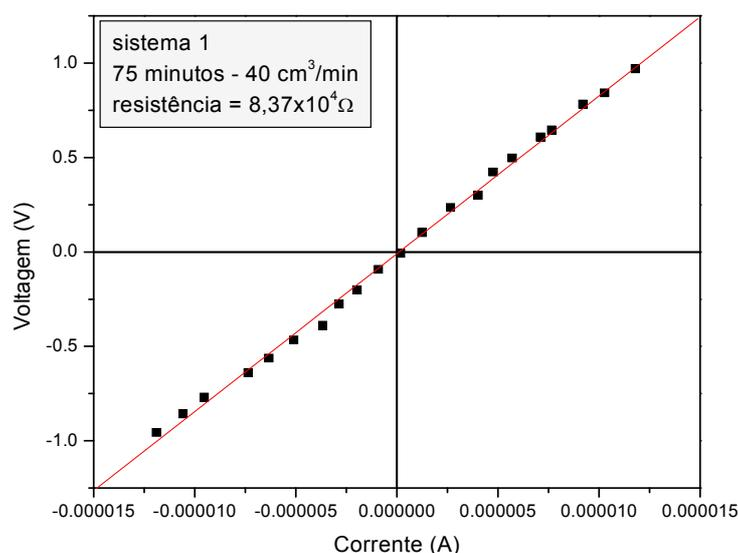
Figura 53: Gráfico de voltagem x corrente da amostra referente a síntese com 75 minutos de patamar.
