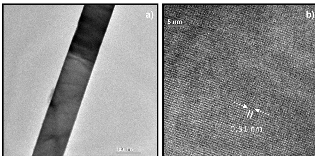
Figura 71: a) Imagem de MET de uma nanofita obtida na síntese com fluxo de  $80 \text{ cm}^3/\text{min}$ . b) Imagem de HRTEM da nanofita apresentada em 71a.
