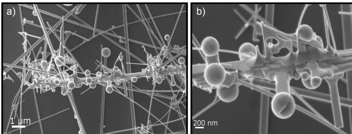
Figura 25: a-b) Imagens de MEV do material referente ao sistema 5 [ $\text{SnO}_2\text{:C}$  (1:1) e  $\text{In}_2\text{O}_3\text{:C}$  (1:1,5)].
