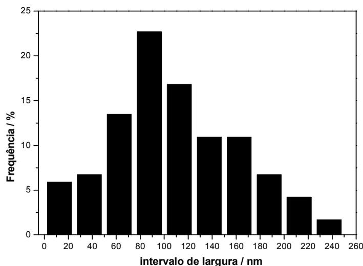
Figura 20: Histograma da distribuição de larguras das nanoestruturas do sistema 3 [SnO<sub>2</sub>:C (1,5:1) e In<sub>2</sub>O<sub>3</sub>:C (1,5:1)].
