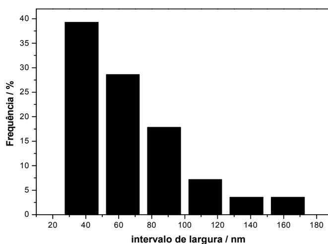
Figura 29: Histograma da distribuição de larguras das nanoestruturas do sistema 6 [ $\text{SnO}_2\text{:C}$  (1:1,5) e  $\text{In}_2\text{O}_3\text{:C}$  (1:1)].
