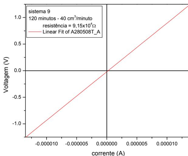
Figura 41: Gráfico de tensão x corrente da amostra referente ao sistema 9 [SnO<sub>2</sub>:C (1:1,5) e In<sub>2</sub>O<sub>3</sub>:C (1,5:1)].
