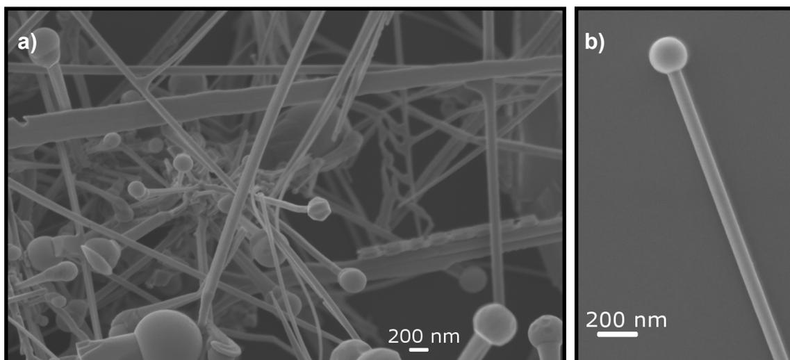
Figura 14: a-b) Imagens de MEV do material referente ao sistema 2 [ $\text{SnO}_2\text{:C}$  (1,5:1) e  $\text{In}_2\text{O}_3\text{:C}$  (1:1)].
