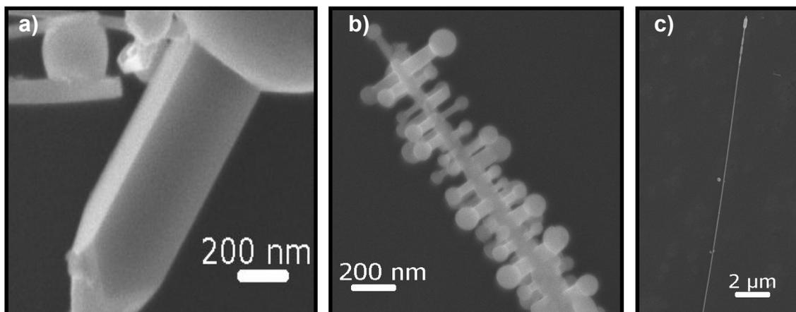
Figura 70: a-b-c) Imagens de MEV de nanoestruturas obtidas na síntese com vazão de fluxo de nitrogênio de  $80 \text{ cm}^3/\text{min}$ .
