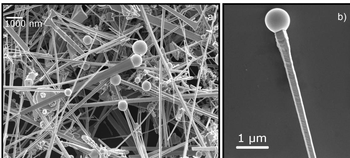
Figura 18: a-b) Imagens de MEV do material referente ao sistema 3 [SnO<sub>2</sub>:C (1,5:1) e In<sub>2</sub>O<sub>3</sub>:C (1,5:1)].
