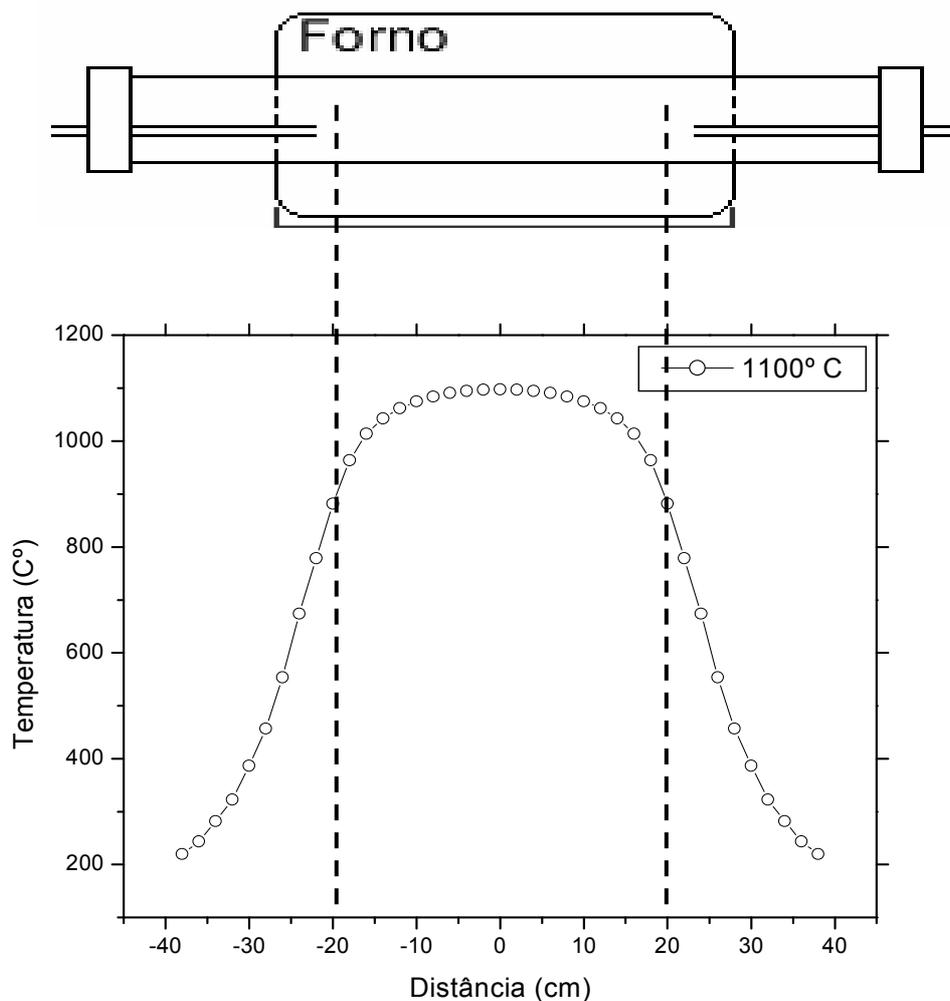
Figura 3: Mapa de temperatura do interior do tubo de alumina do forno utilizado para sínteses de nanoestruturas de ITO. Esse mapa foi realizado na temperatura de 1100° C.
