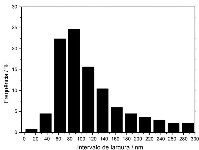
Figura 59: Histograma da distribuição de larguras das nanoestruturas da síntese com patamar de 45 minutos.
