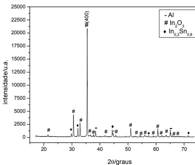
Figura 5: Difratograma de raios X do material coletado após a realização da síntese do sistema 1 [ $\text{SnO}_2:\text{C}$  (1:1) e  $\text{In}_2\text{O}_3:\text{C}$  (1:1)].
