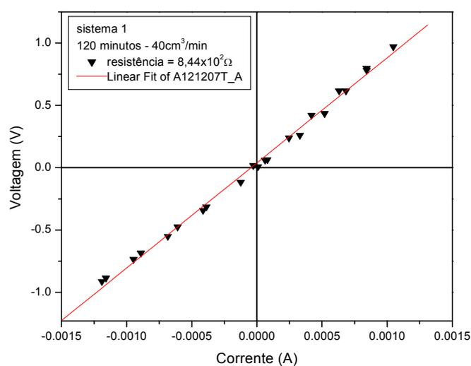
Figura 12: Gráfico de voltagem x corrente referente a amostra do sistema 1 [ $\text{SnO}_2\text{:C}$  (1:1) e  $\text{In}_2\text{O}_3\text{:C}$  (1:1)].
