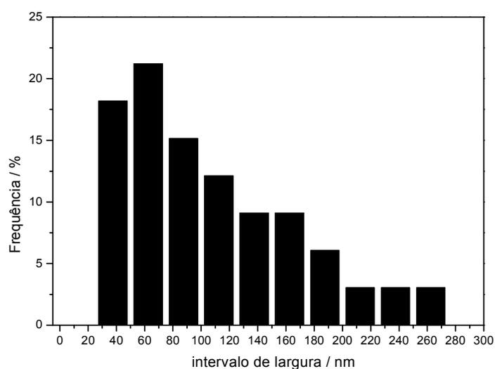
Figura 78: Histograma da distribuição de larguras das nanoestruturas obtidas na síntese com vazão de fluxo de nitrogênio de  $20 \text{ cm}^3/\text{min}$ .
