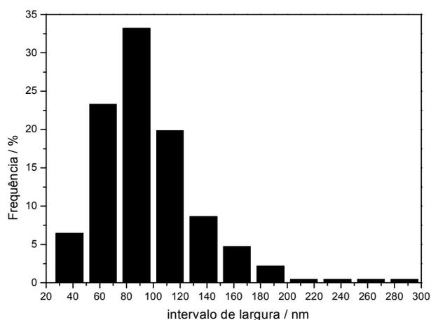
Figura 38: Histograma de distribuição de larguras das nanoestruturas do sistema 9 [ $\text{SnO}_2\text{:C}$  (1:1,5) e  $\text{In}_2\text{O}_3\text{:C}$  (1,5:1)]
