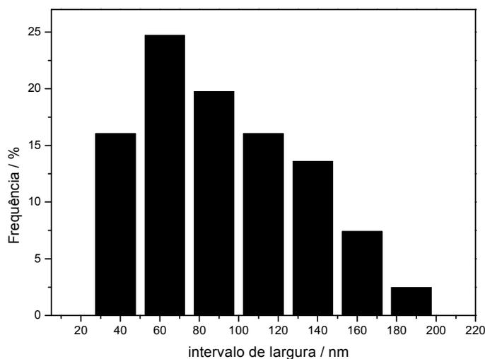
Figura 56: Histograma da distribuição de larguras das nanoestruturas obtidas na síntese com patamar de 60 minutos.
