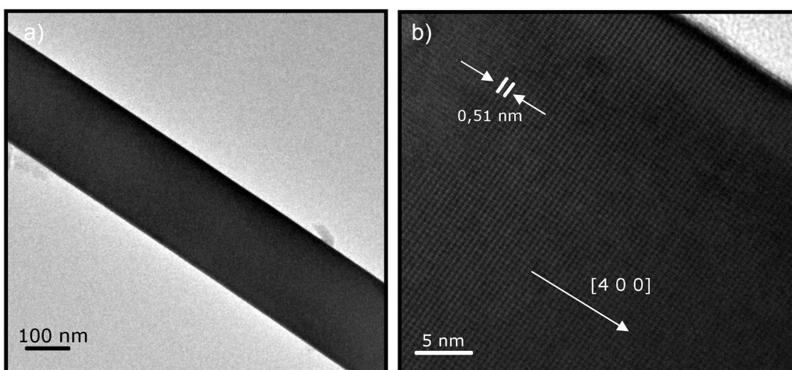
Figura 39: a) Imagem de MET de uma nanofita. b) Imagem de HRTEM da nanofita da figura 39a.
