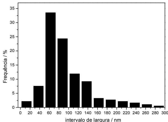
Figura 46: Histograma de distribuição de larguras das nanoestruturas obtidas na síntese com 120 minutos de patamar.
