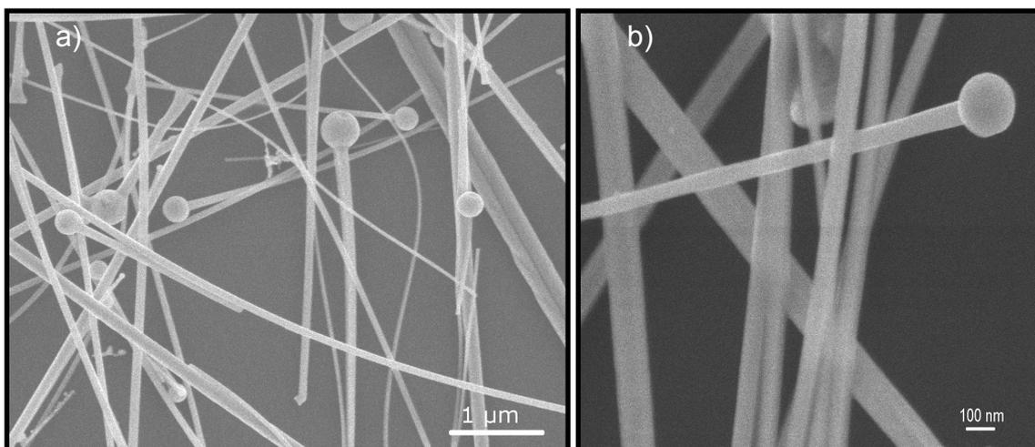
Figura 6: a-b) Imagens de MEV do material referente ao sistema 1 [ $\text{SnO}_2\text{:C}$  (1:1) e  $\text{In}_2\text{O}_3\text{:C}$  (1:1)].
