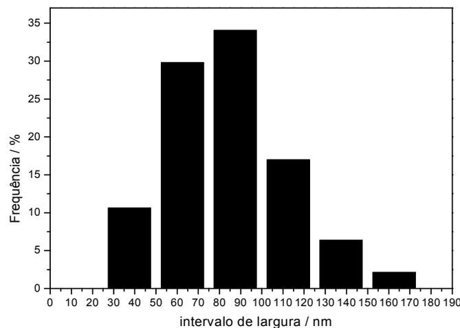
Figura 67: Histograma da distribuição de larguras das nanoestruturas obtidas na síntese com vazão de fluxo de nitrogênio de 160 cm<sup>3</sup>/min.
