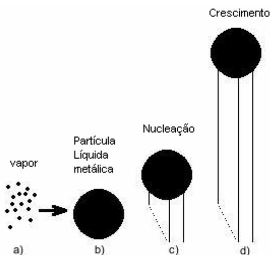
Figura 43: Ilustração esquemática do modelo de crescimento por vapor-líquido-sólido (VLS) das nanofitas de ITO.
