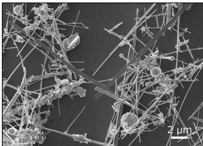
Figura 19: Imagem de MEV do material referente ao sistema 3 [SnO<sub>2</sub>:C (1,5:1) e In<sub>2</sub>O<sub>3</sub>:C (1,5:1)].
