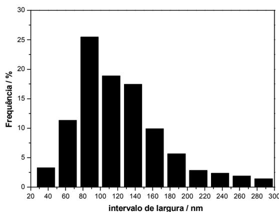
Figura 7: Histograma da distribuição de larguras das nanoestruturas do sistema 1 [ $\text{SnO}_2\text{:C}$  (1:1) e  $\text{In}_2\text{O}_3\text{:C}$  (1:1)].
