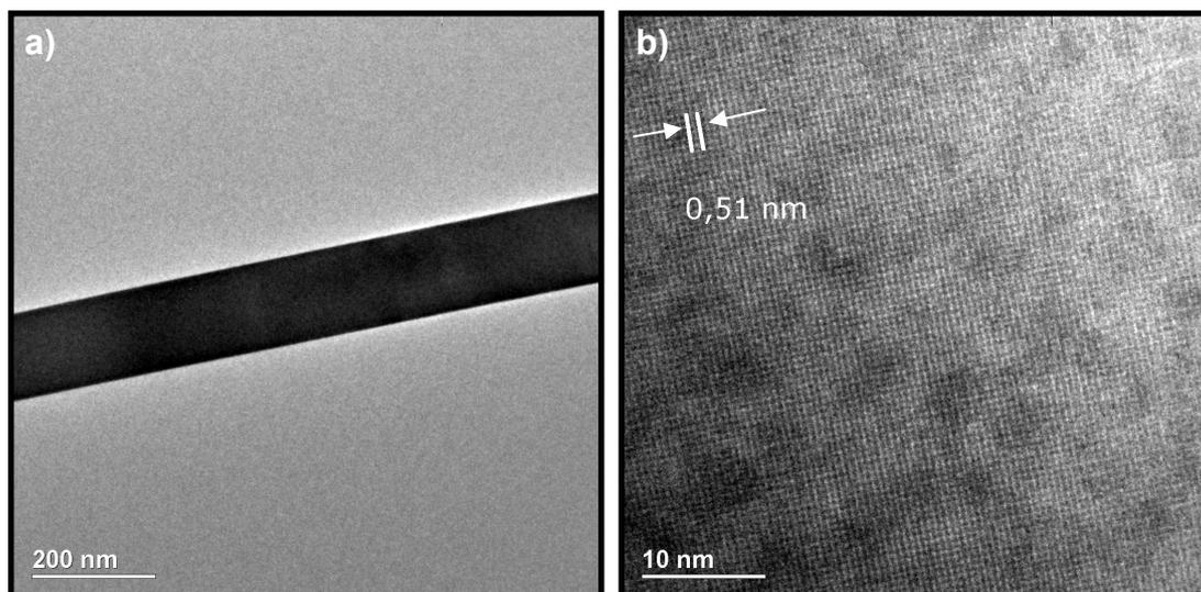
Figura 75: a) Imagem de MET de uma nanofita obtida na síntese com vazão de fluxo de nitrogênio de  $60 \text{ cm}^3/\text{min}$ . b) Imagem de HRTEM da nanofita da figura 75a.
