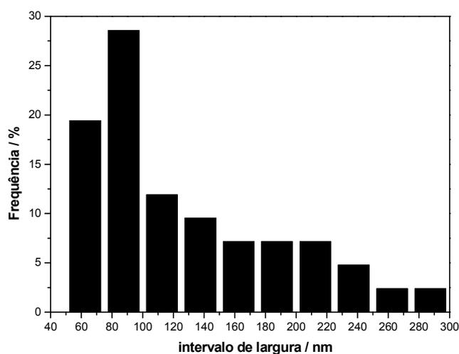
Figura 26: Histograma da distribuição de larguras das nanoestruturas do sistema 5 [ $\text{SnO}_2\text{:C}$  (1:1) e  $\text{In}_2\text{O}_3\text{:C}$  (1:1,5)].
