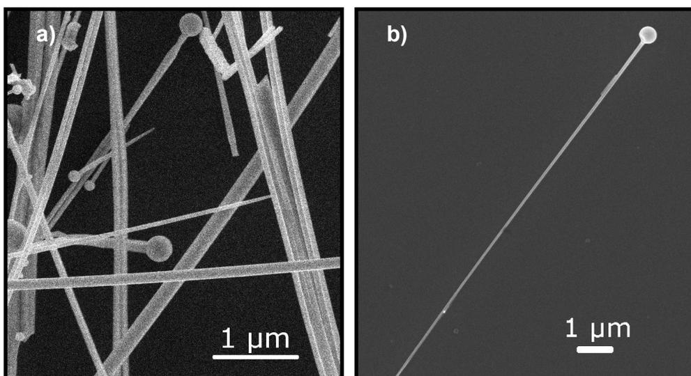
Figura 66: a-b) Imagens de MEV das nanoestruturas obtidas na síntese com vazão de fluxo de nitrogênio de  $160 \text{ cm}^3/\text{min}$ .
