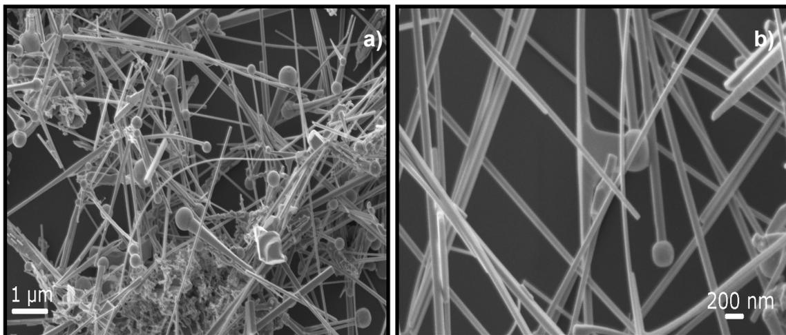
Figura 22: a-b) Imagens de MEV do material referente ao sistema 4 [ $\text{SnO}_2\text{:C}$  (1:1) e  $\text{In}_2\text{O}_3\text{:C}$  (1,5:1)].
