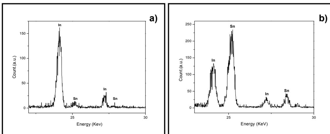
Figura 10: a-b) Espectros de EDS da nanofita da figura 9 e da esfera, respectivamente, do sistema 1.
