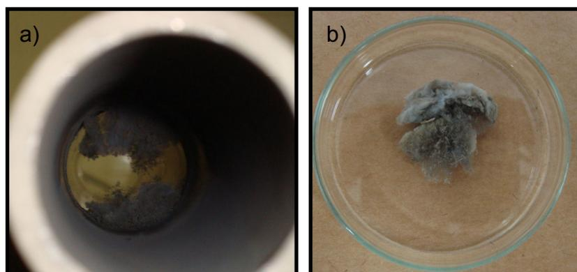
Figura 4: a-b) Foto das nanoestruturas formadas na parede interna do tubo utilizado para a realização das sínteses e das nanoestruturas já coletadas.
