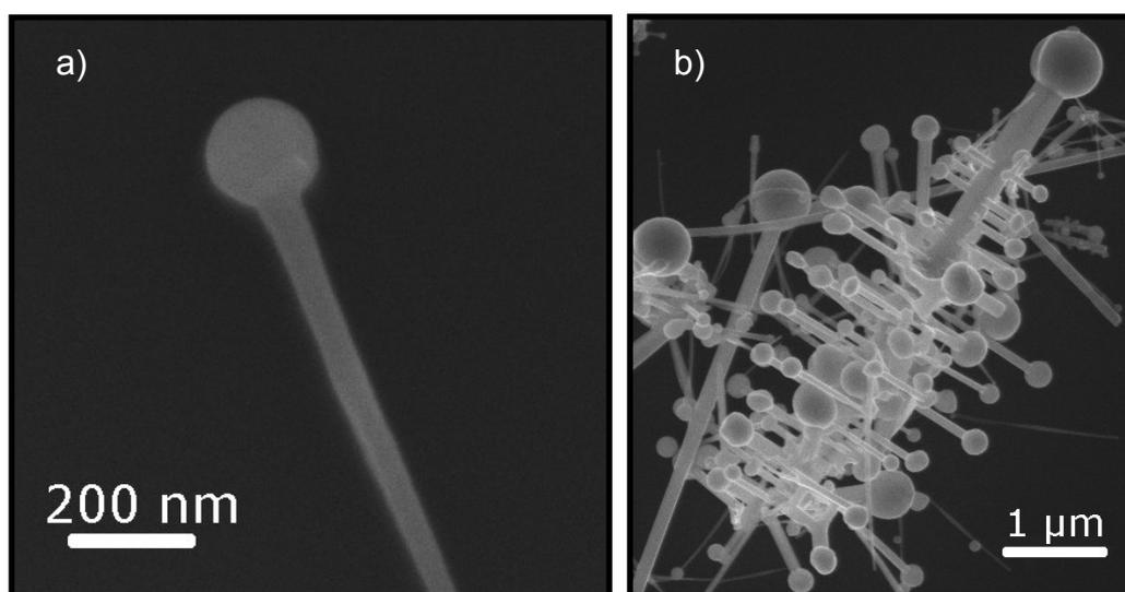
Figura 47: a-b) Imagens de MEV das nanoestruturas obtidas na síntese com tempo de patamar de 105 minutos.
