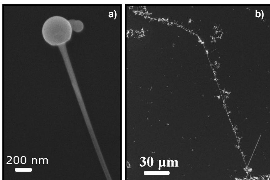
Figura 54: a-b) Imagens de MEV das nanoestruturas obtidas na síntese com tempo de patamar de 60 minutos.
