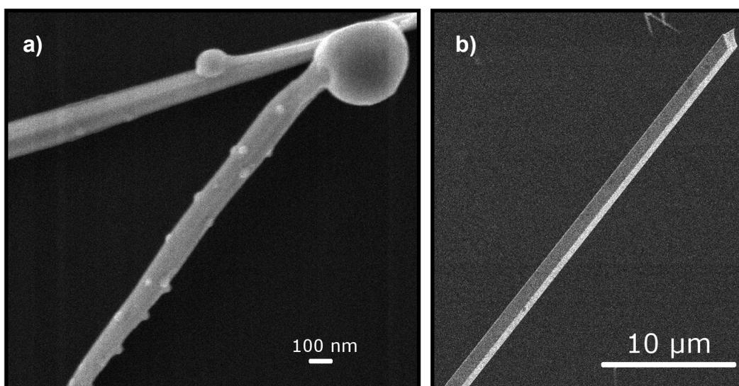
Figura 68: a-b) Imagens de MEV das nanoestruturas obtidas na síntese com vazão do fluxo de nitrogênio de  $120 \text{ cm}^3/\text{min}$ .
