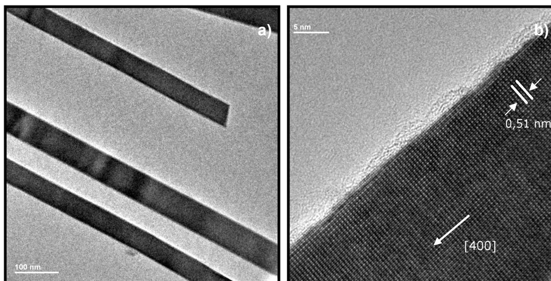
Figura 11: a) Imagem de MET de nanofitas do sistema 1; e b) imagem de HRTEM de uma nanofita do sistema 1.
