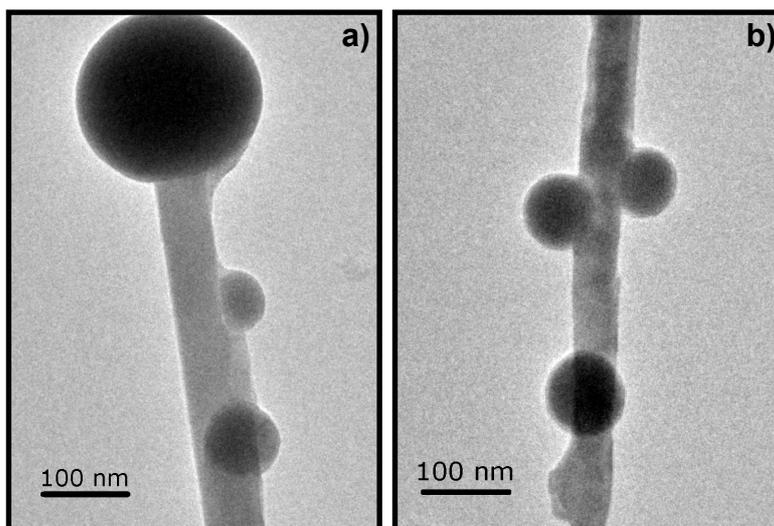
Figura 9: a-b) Imagens de MET do material referente ao sistema 1 [ $\text{SnO}_2\text{:C}$  (1:1) e  $\text{In}_2\text{O}_3\text{:C}$  (1:1)].
