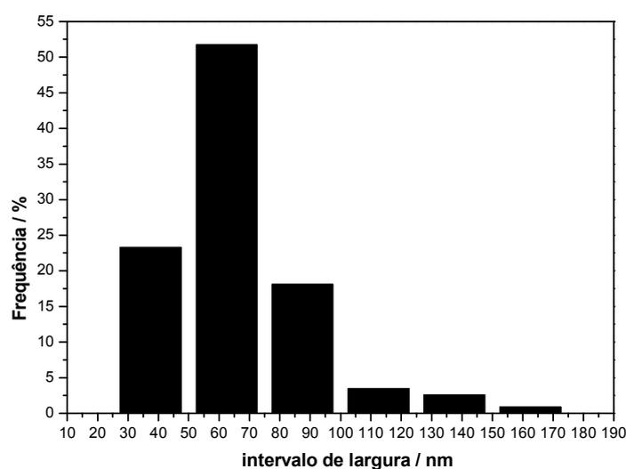
Figura 35: Histograma de distribuição de larguras das nanoestruturas do sistema 8 [ $\text{SnO}_2\text{:C}$  (1,5:1) e  $\text{In}_2\text{O}_3\text{:C}$  (1:1,5)].
