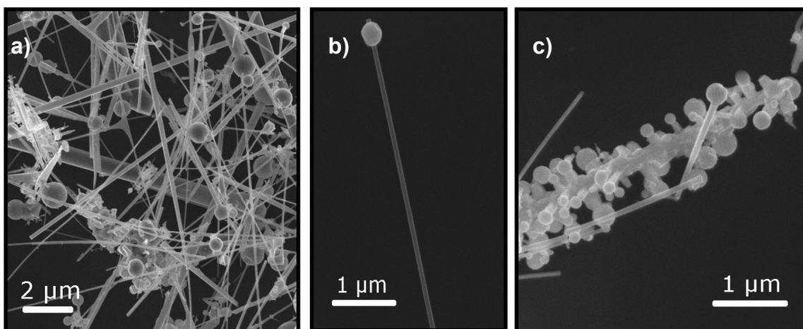
Figura 58: a-b-c) Imagens de MEV das nanoestruturas obtidas na síntese com patamar de 45 minutos.
