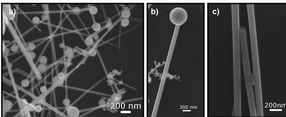
Figura 60: a-b-c) Imagens de MEV das nanoestruturas obtidas na síntese com tempo de patamar de 30 minutos.
