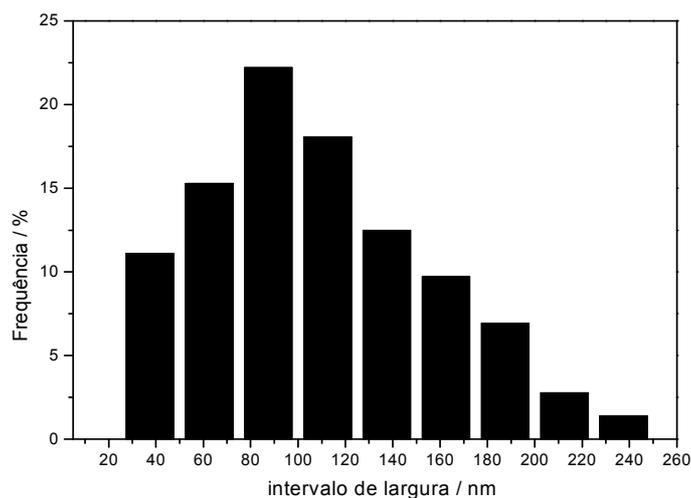
Figura 52: Histograma da distribuição de larguras das nanoestruturas obtidas na síntese com tempo de patamar de 75 minutos.
