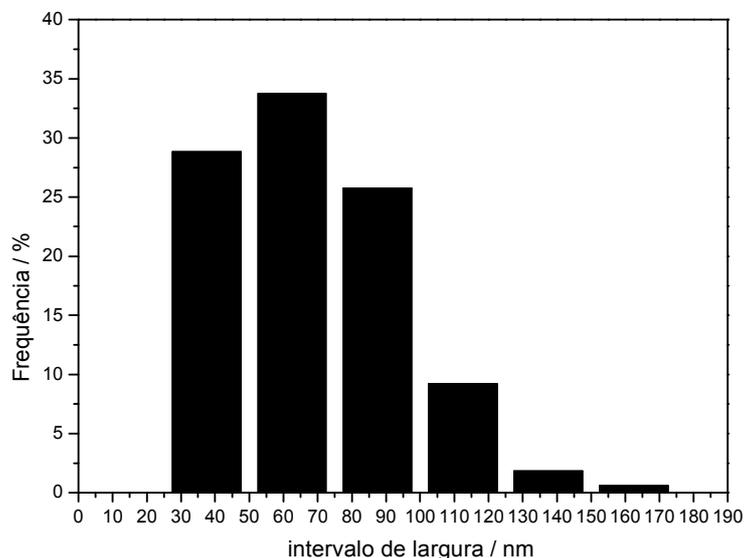
Figura 48: Histograma de distribuição de larguras das nanoestruturas obtidas na síntese com 105 minutos de patamar.
