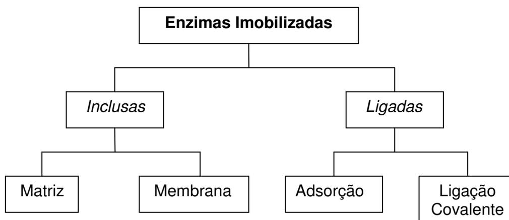
**Figura 3.5** – Principais métodos de imobilização de enzimas.
