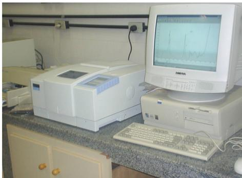
**Figura 4.3** – Espectrofotômetro de Infravermelho utilizado para a caracterização do éster.
