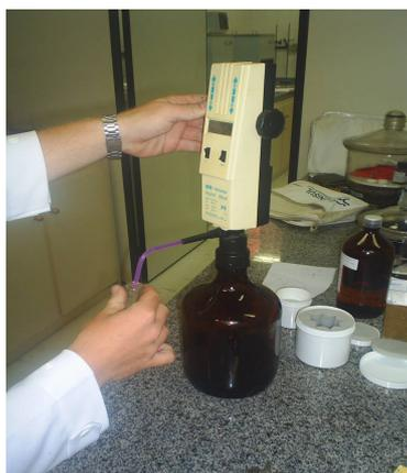
**Figura 4.2** – Bureta digital utilizada nas titulações ácido-base.
