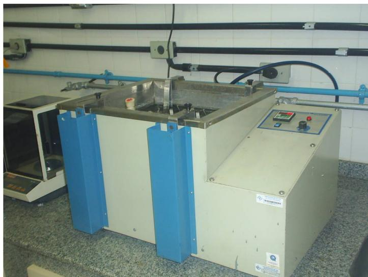
**Figura 4.1** – Banho-maria tipo DUB-NOFF utilizado para conduzir a síntese do éster.
