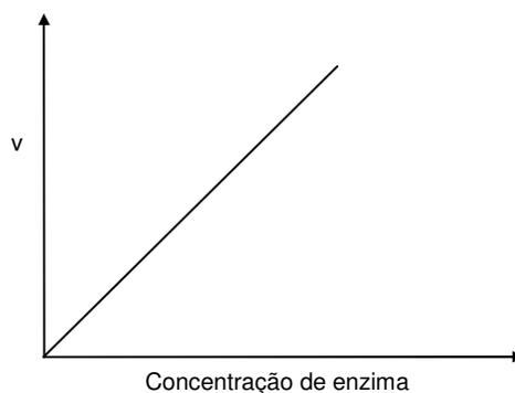
**Figura 3.13** – Influência da concentração de enzima na velocidade inicial da reação.
