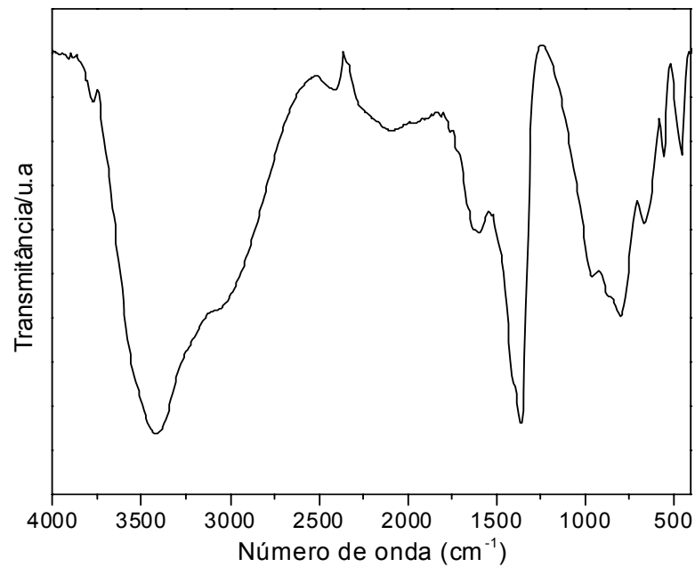
Figura 17. Espectro no infravermelho do HDL de MgAl-CO 3 .
