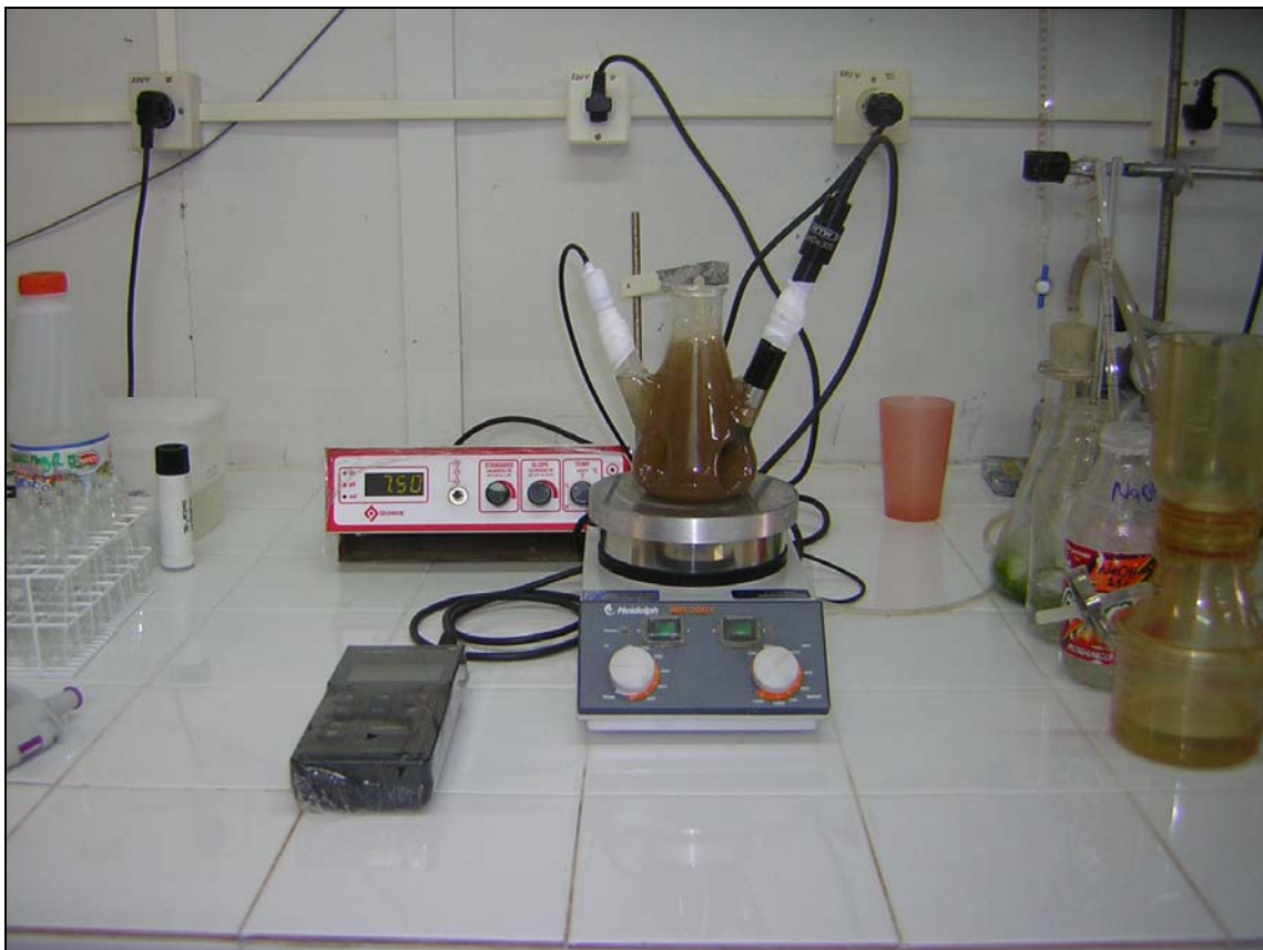
Figura 4.2: Sistema operacional utilizado em ensaios de respirometria.
