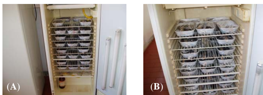
FIGURA 6 Aspecto geral (A) e detalhe (B) da disposição das bandejas no interior de câmaras tipo BOD, durante o condicionamento fisiológico das sementes.
