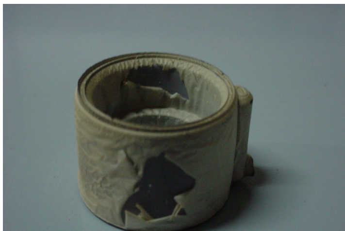
Figura 29. - Detalhe de peça apresentando filme após a sua sinterização. Película quebrada, mostrando sua fina espessura.
