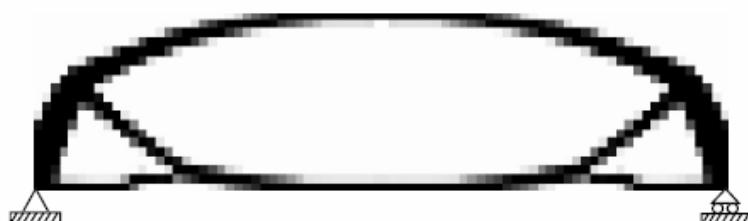
Figura 5.5.26 – Domínio e tipos de suporte viga MBB Bruyneel e Duysinx (2004).
