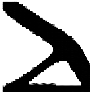
Figura 4.6.18 - RR=6%,RRI=1%, ER=1%, VI=40%. VRI=1,75%, 8000 elementos triangulares, Iteração 125 - malha (100x40) - SESO.
