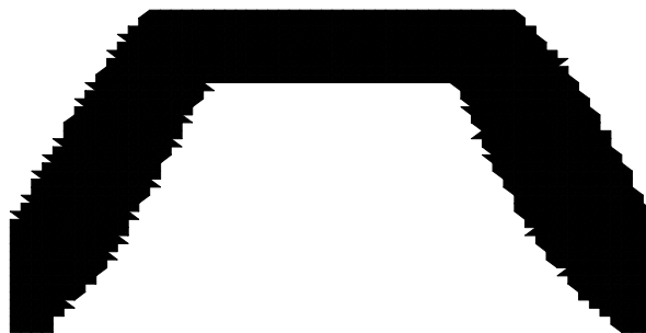
Figura 5.4.45 – RR=6,75%, RRI=1%,ER=0,75%, VRI=5%,4768 elementos triangulares, Iteração 130 – malha (60x40) – SESO
