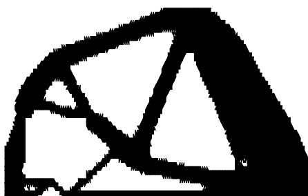
Figura 5.4.22b – RR=5%, RRI=1%,ER=1%, VRI=1,75%,13200 elementos triangulares, Iteração 116 – malha (150x47) – SESO
