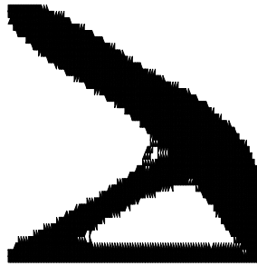
Figura 4.6.13 - RR=4%,RRI=1%, ER=1%, VI=40% VRI=1,75%, 8000 elementos triangulares, Iteração 142 - malha (100x40) - ESO.
