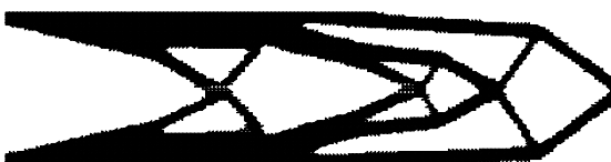
Figura 5.6.11 - RR=6,25%, RRI=1%,ER=1,25%, VRI=5%,19200 elementos triangulares, Iteração 95 - malha (160x60) – SESO
