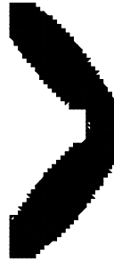
Figura 5.4.7 – RR=6,0%, RRI=1%,ER=0,75% VRI=1,75%,2824 elementos triangulares, Iteração 89 – malha (25x60) - SESO
