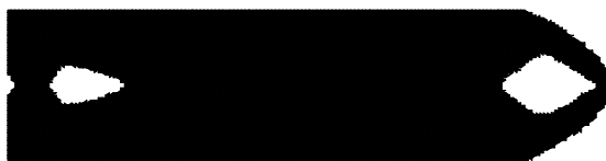
Figura 5.6.9 - RR=2,5%, RRI=1%,ER=1,25%, VRI=5%,19200 elementos triangulares, Iteração 19 - malha (160x60). – SESO
