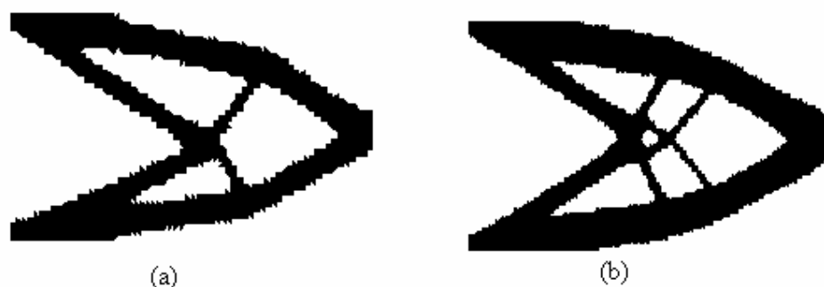
Figura 2.5 – Dependência da malha no problema de OT com restrição de tensão VM: (a) malha com 3840 elementos triangulares (b) malha com 19200 elementos triangulares.
