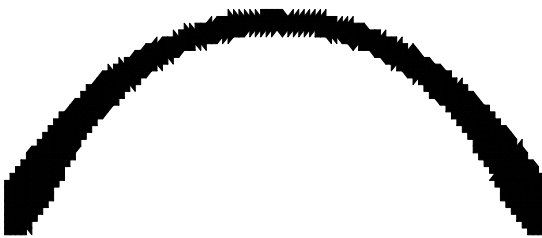
Figura 5.5.17 – RR=13,75%, RRI=1%,ER=1,25%, VRI=10%, 8000 elementos triangulares, Iteração 190 – malha (100x40) – SESO
