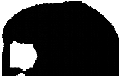
Figura 5.4.19 – RR=2%, RRI=1%,ER=1%, VRI=1,75%,13200 elementos triangulares, Iteração 58 – malha (150x47) - ESO
