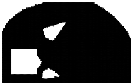
Figura 5.4.21 – RR=3%, RRI=1%,ER=1%, VRI=1,75%,13200 elementos triangulares, Iteração 34 – malha (150x47) – SESO
