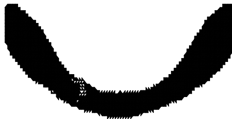
Figura 5.5.21 – RR=3%, RRI=1%,ER=1%, VRI=10%,6478 elementos triangulares, Iteração 129 – malha (90x36) – ESO
