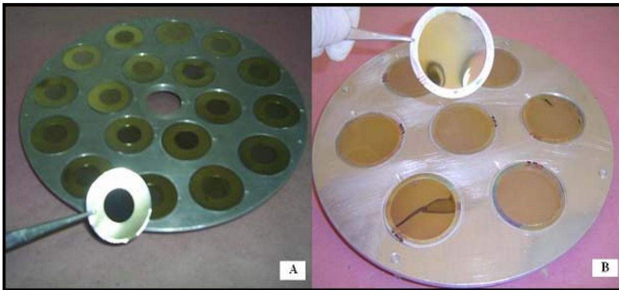
FIGURA 2.5 (A) - Arandelas com Collodion metalizados para o depósito das fontes. (B) - Arandelas com Collodion metalizados para absorção das partículas \beta .
