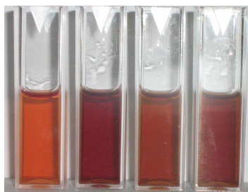
Figura 15. Soluções em etanol de HB, HB:La 3+ (1:2), HB:Eu 3+ (1:2) e HB:Tb 3+ (1:2), da esquerda para a direita, com concentração de HB igual a 70 \mu M.
