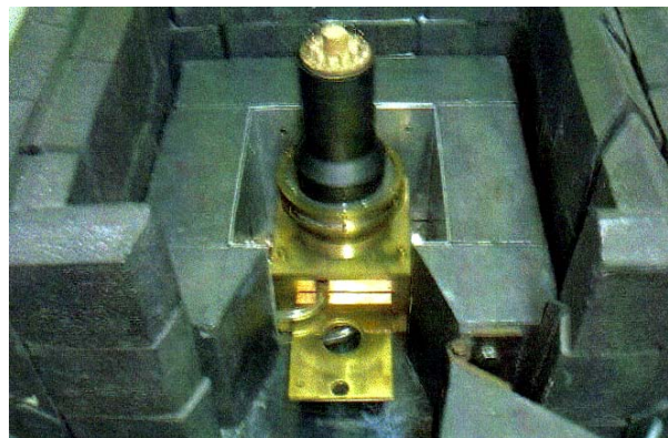
Figura 5. Foto de um detector cintilador de NaI(Tl) acoplado a um contador proporcional [23] .
