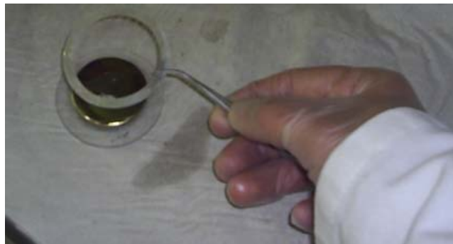
Figura 13. Foto da colocação de um absorvedor de Collodion sobre uma fonte de ^{201}\text{Tl} .
