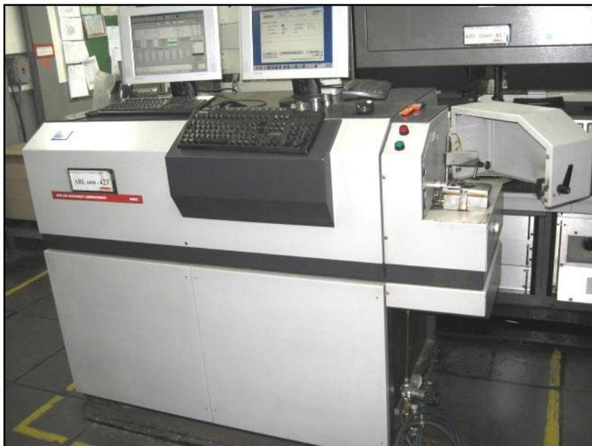
**FIGURA 6** – Espectrômetro de emissão óptica de arco voltaico (OES-*spark*) da ARL, modelo ARL 4460, 2001
