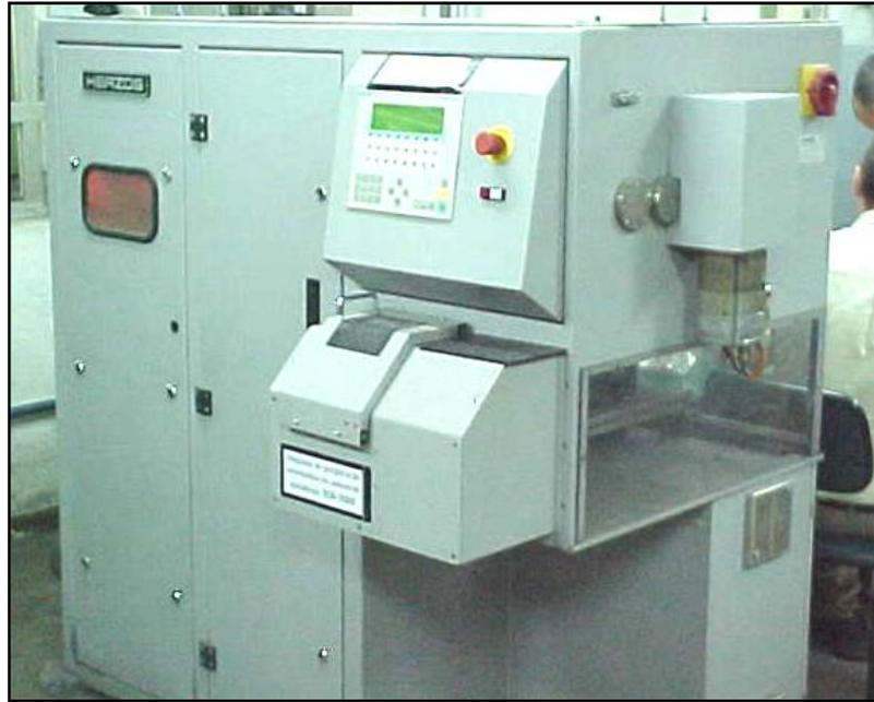
**FIGURA 8** – Sistema automático de preparação de amostras metálica, HERZOG HB-3000.
