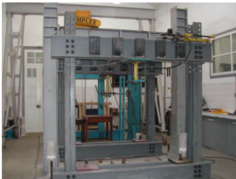
Foto 1 – Pórticos de Reação.
