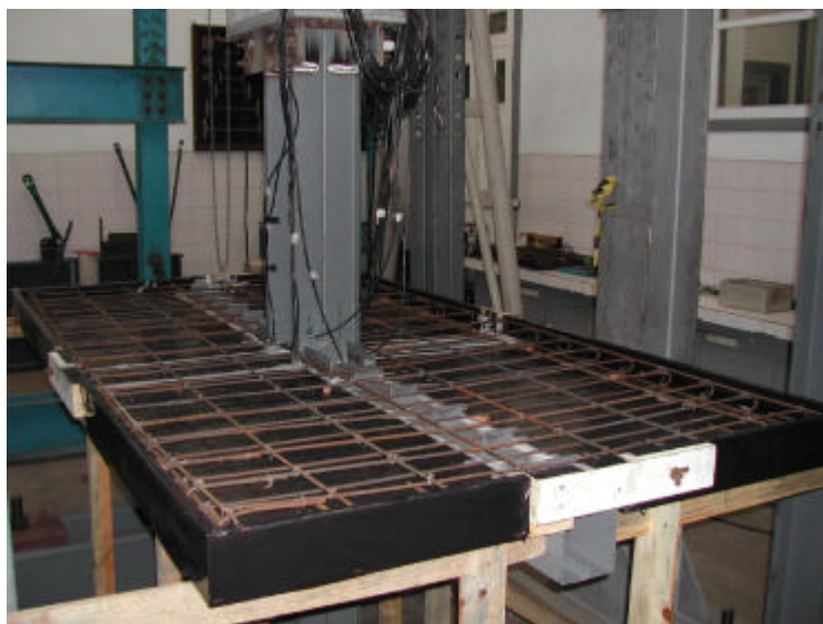
Figura 4.16 – Foto das armaduras da laje do Protótipo A.
