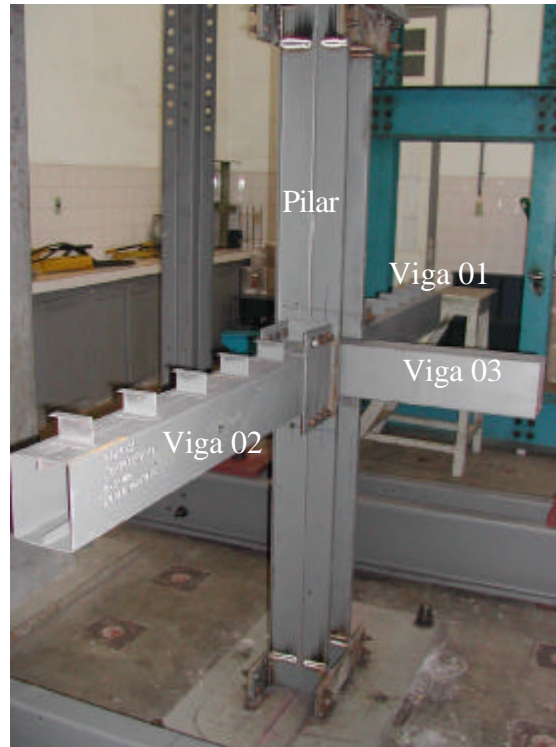
Figura 4.14 – Foto da montagem do pilar e das vigas do Protótipo A.
