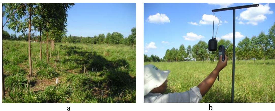
Figura 2. Estudo prévio do local de colocação do globo negro (a) e coleta das variáveis ambientais com o globo negro e termo-higro-anemômetro (THAL 300 ® ) (b).
