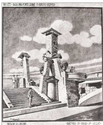
Fig. 38- Detalhe do Pílo para amarração de barcos, e da escadaria de ligação entre o canal navegável e a Rua.
