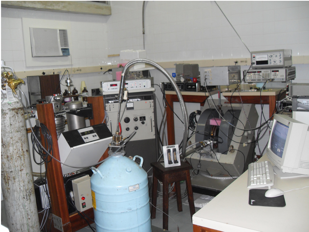
Figura 2.16: Foto da montagem de ressonância ferromagnética, adaptada ao sistema realizar medidas em baixa temperatura.
