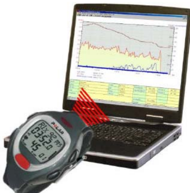
Figura 14: Transmissão do sinal do monitor Polar S 810i para o software Polar Precision Performance ® via infravermelho.
