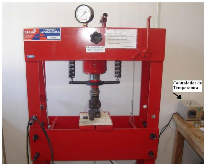
Figura 4.1 Prensa Hidráulica (30 Ton) com controlador de temperatura Contemp.
