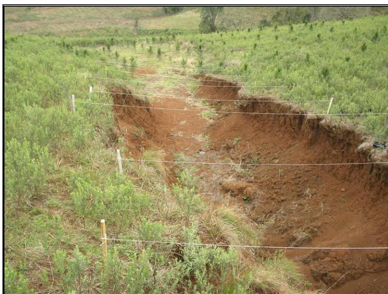
**Figura 7. Estacas instaladas a 50 cm das bordas da voçoroca para monitoramento dos volumes de solo erodidos nas bordas e nas cabeceiras da incisão.**
