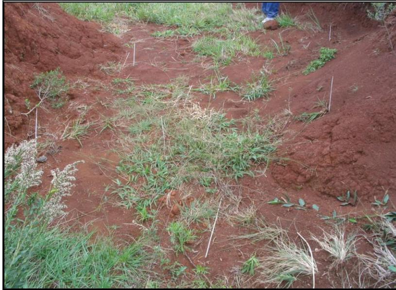
**Figura 8. Pinos fixos utilizados para o monitoramento dos volumes de erosão dentro do canal.**
