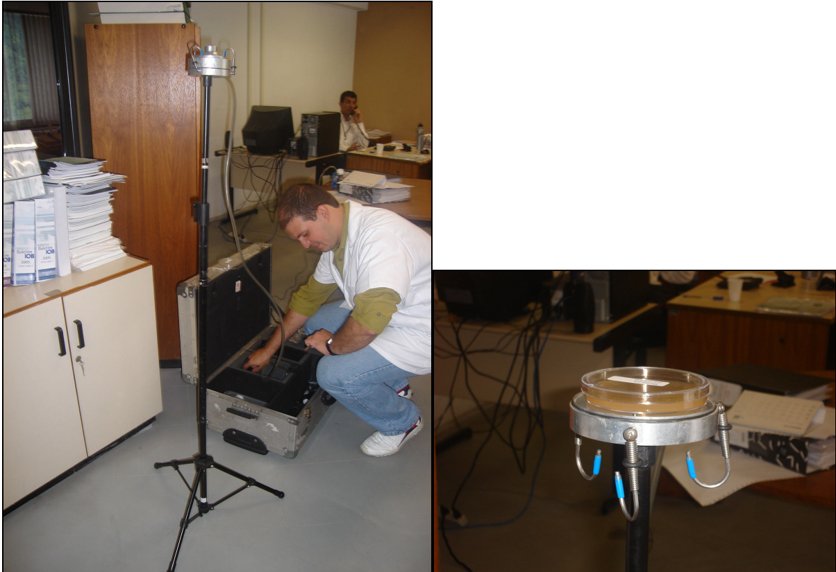
Figura 14. Impactador tipo Andersen. No detalhe, o compartimento aberto, mostrando a Placa de Petri
