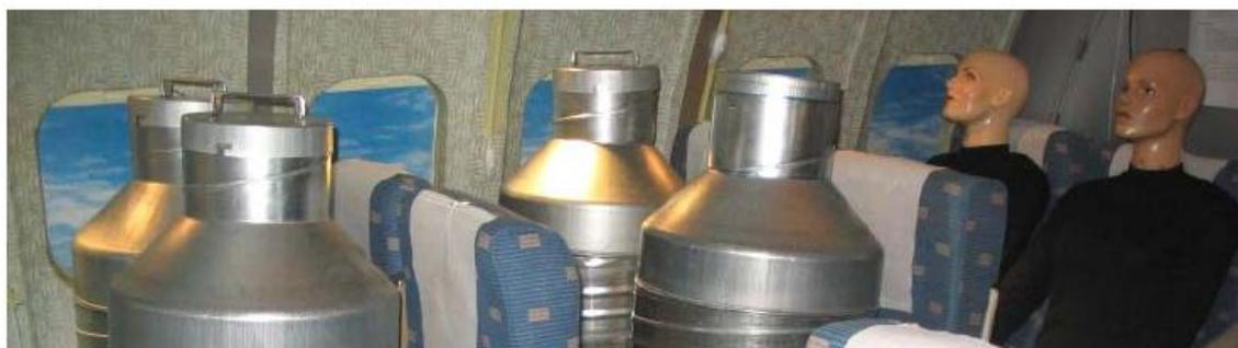
**Figura 1.2** - Detalhe do mock-up mostrando os manequins e cilindros aquecidos (Strøm-Tejsen et al., 2007).
