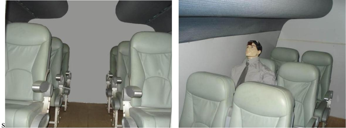
**Figura 4.15** Vistas internas do *mock-up* instalado, mostrando as poltronas, o *bin* e um manequim instrumentado.
