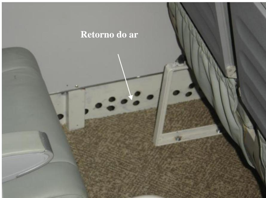
**Figura 4.14** Detalhes do retorno de ar
