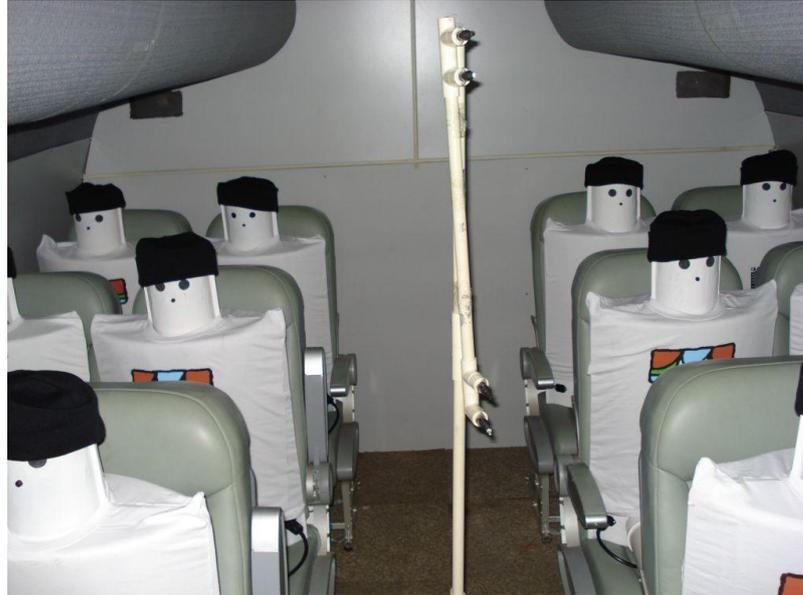
**Figura 5.1-** Posicionamento dos manequins aquecidos e de um dos pedestais no *mock-up*.
