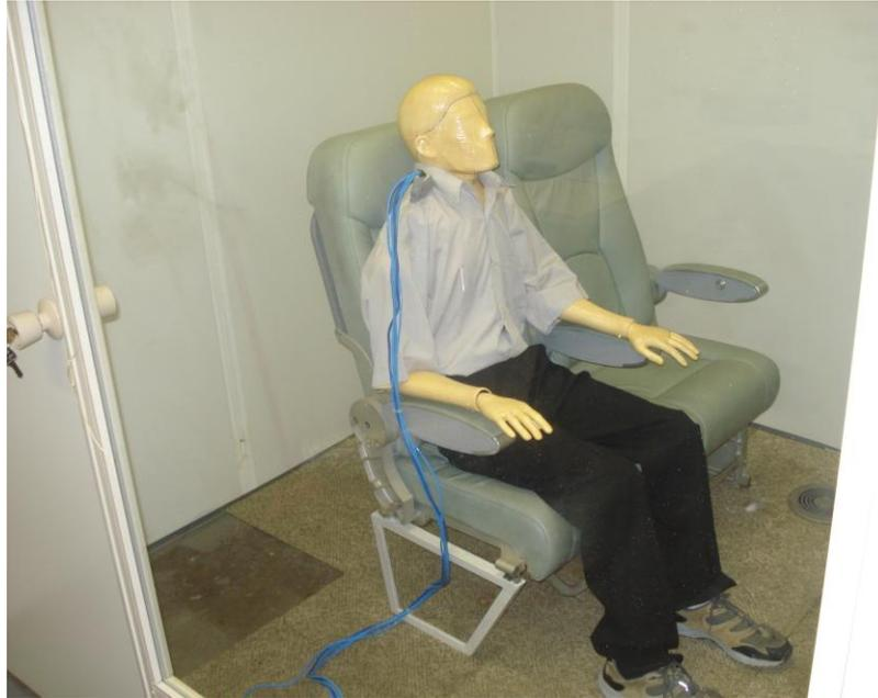
**Figura 5.6** Manequim térmico na câmara de calibração
