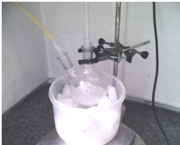
Figura 19 – Preparação da resina epóxi: o resfriamento foi efetuado antes da adição do agente de cura para prevenir processo de cura acentuada na mistura.
