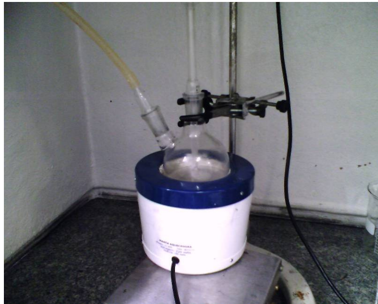
Figura 18 – Preparação da resina epóxi: aquecimento e vácuo para eliminação de bolhas.
