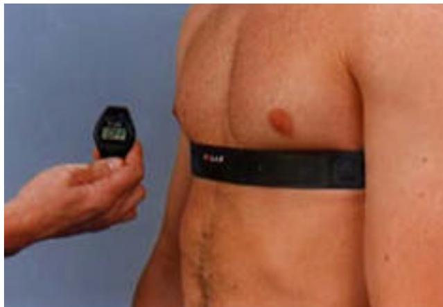
**Figura 2: Sensor WearLink® e Monitor Cardíaco Polar S810i® posicionado no tórax para captação do intervalo RR.**
