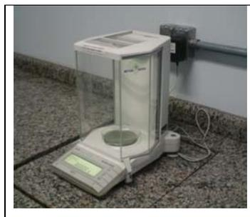
Figura 4 - Balança analítica
