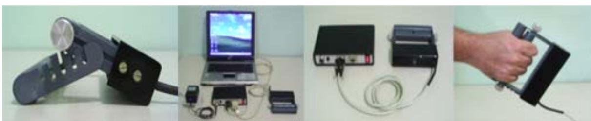
Figura 1. Dinamômetro de Preensão Manual Digital Cefise.
