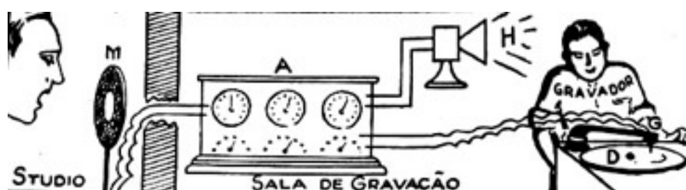
FIGURA 3.1: Figura retirada da Revista Phono-Arte que ilustra o processo de registro elétrico do som.
