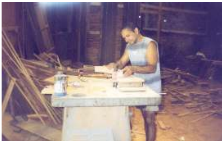
Foto 21 - Seu Sebastião utilizando a Topia, máquina com a função de tornar a madeira e fazer baixos relevos. Shirley Monteiro em: 08/2004
