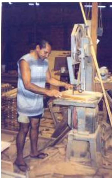
Foto 22 - Seu Sebastião utilizando a serra de fita, máquina para serrar madeira. Shirley Monteiro em 08/2004
