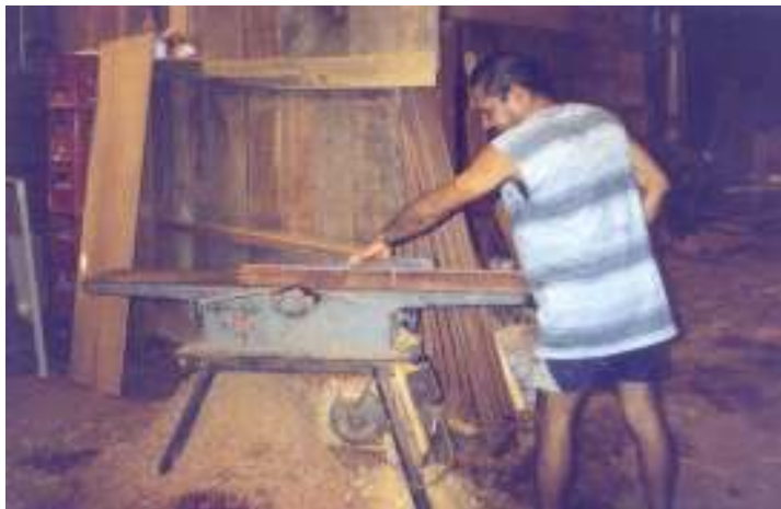
Foto 19 – Máquina utilizada na fabricação de móveis: Juntora tem a função de “fatiar a madeira”. Seu Sebastião demonstra como usa-la. Shirley Monteiro em 08/2004.
